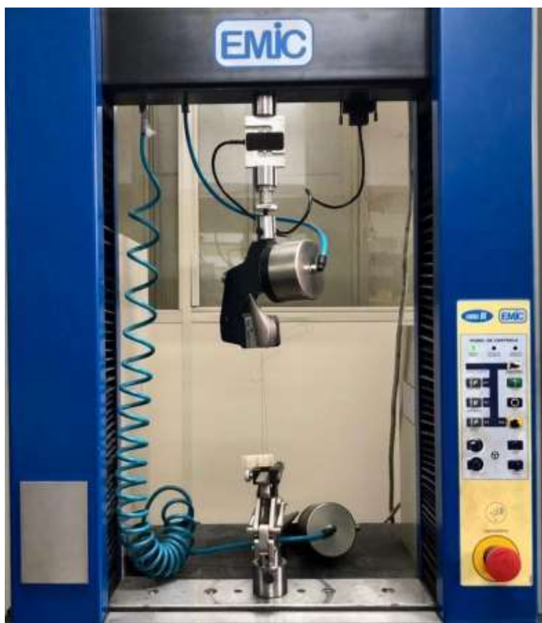
FIGURA 3.1. Máquina universal para ensaios mecânicos - EMIC com amostra posicionada e dispositivo para ensaio mecânico de cisalhamento.
