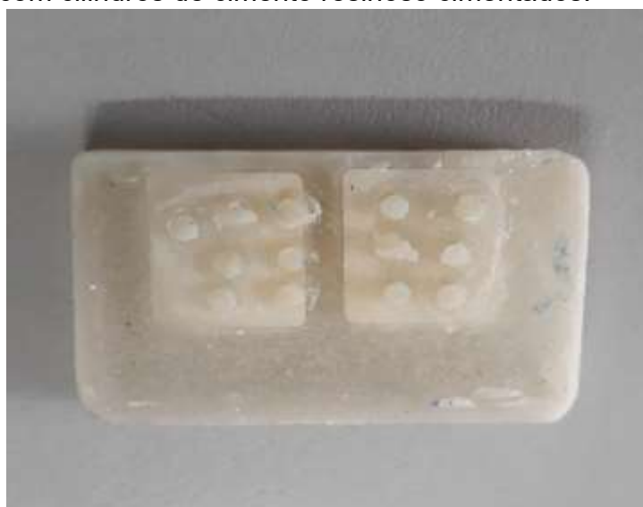
FIGURA 2.1 Amostra embutida em resina acrílica para ensaio de cisalhamento com cilindros de cimento resinoso cimentados.
