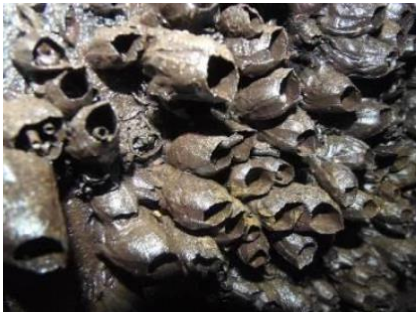
Figura 31. Registro fotográfico da comparação da bioincrustação sobre a parede da Galeria G1 com o Recrutamento da bioincrustação sobre o Quadro Q2G1.
