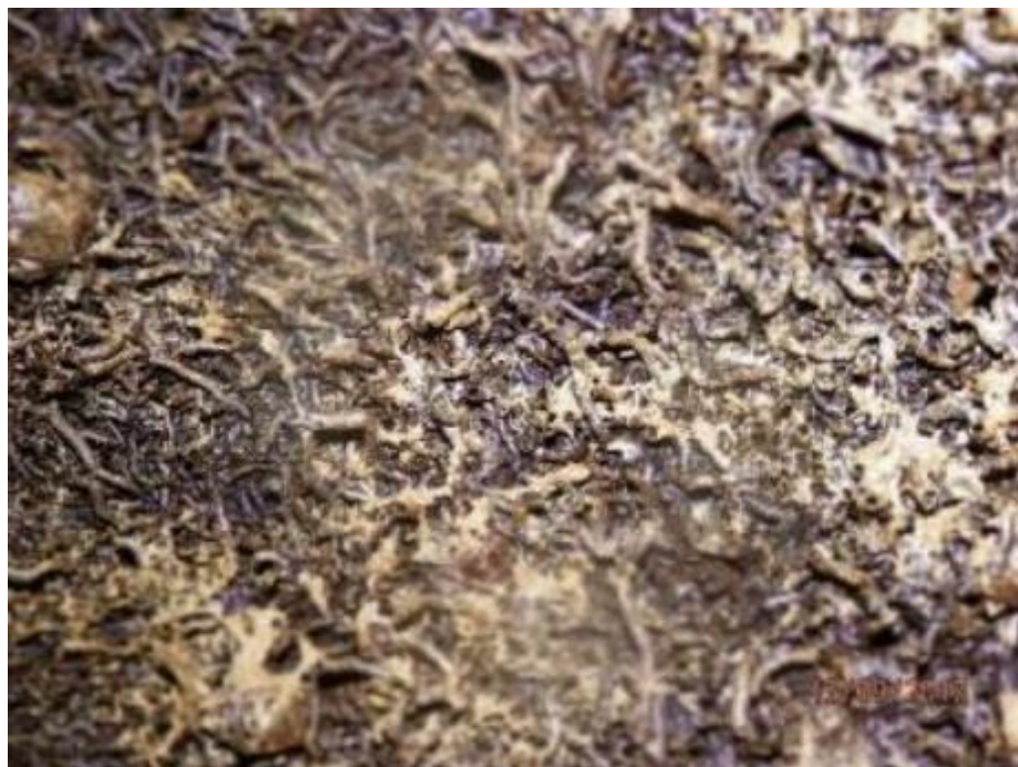
Figura 47. Registro fotográfico da comparação da bioincrustação sobre a parede do Túnel T com o Recrutamento da bioincrustação sobre o Quadro Q6T
