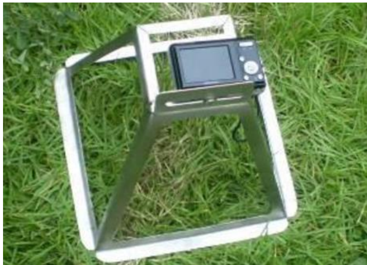
Figura 17. Câmera fotográfica NIKON semiprofissional acoplada a uma Frame de aço inox metálico 20 x 20 cm (400 cm 2 ) para execução.
