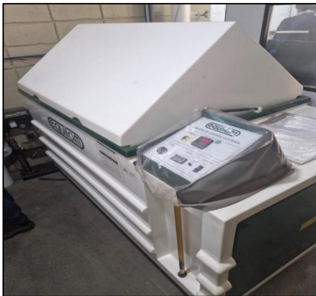
Figura 13. Equipamento de ensaio de câmara úmida
