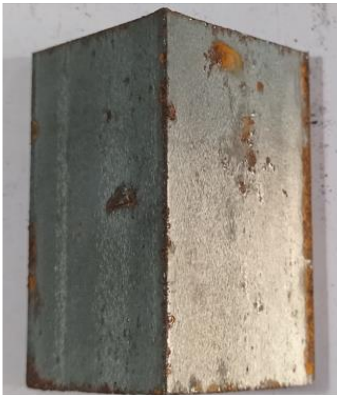
Figura 37. Amostra 1.1 com carepa
