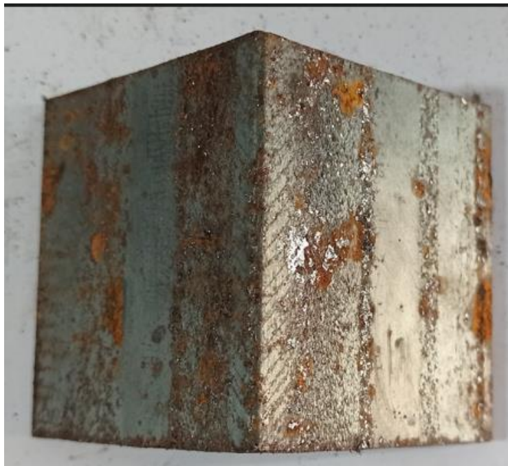
Figura 39. Amostra 3.1 com carepa
