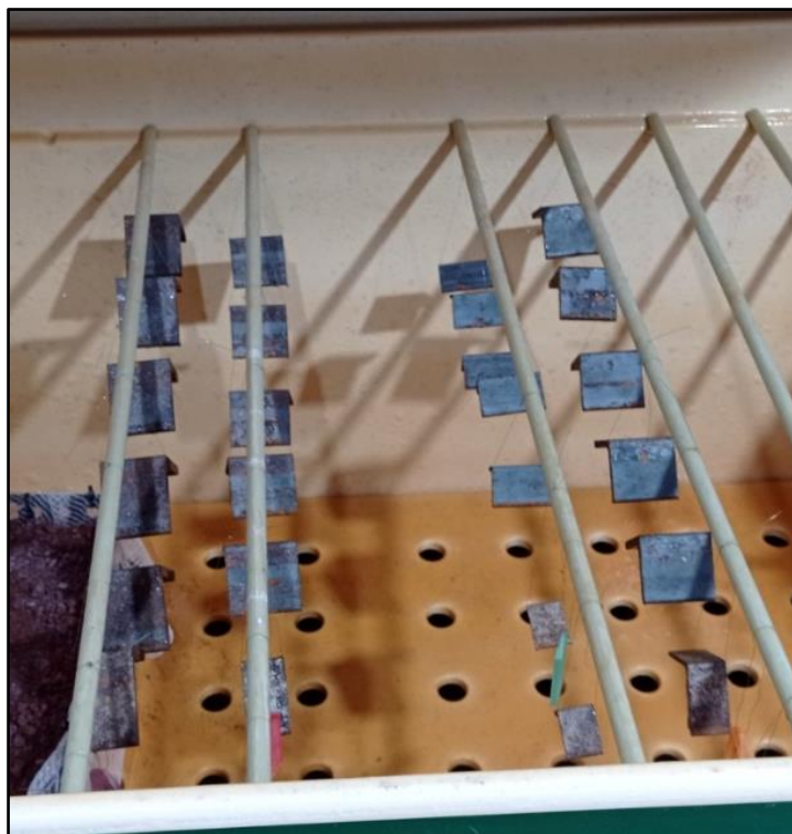
Figura 35. Visão geral dos corpos de prova após 210 dias de ensaio (27/04/25)
