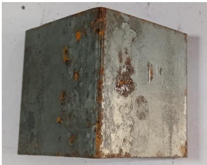
Figura 38. Amostra 2.1 com carepa
