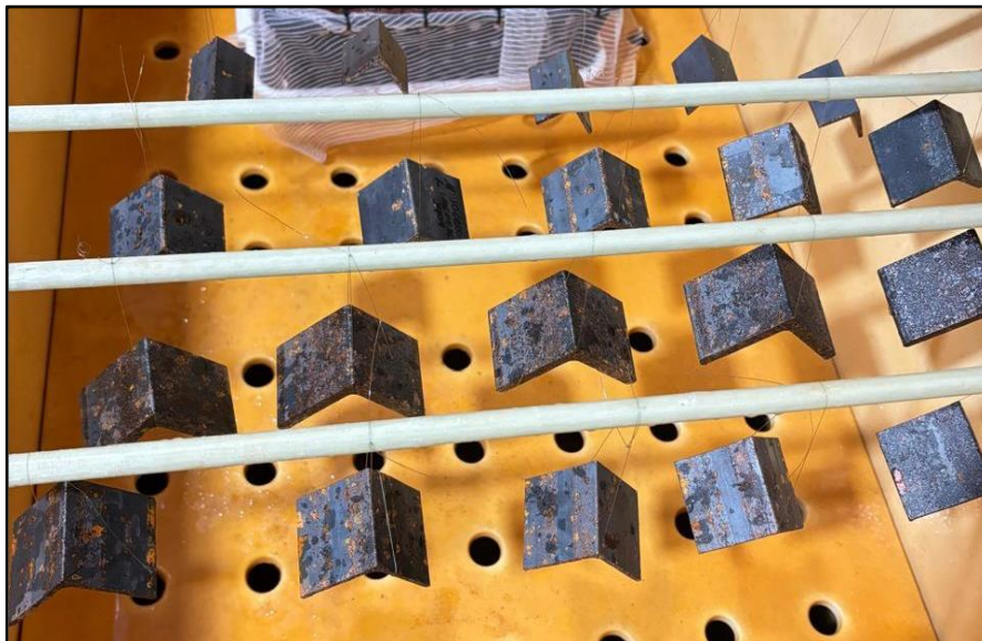
Figura 24. Visão geral dos corpos de prova após 28 dias de ensaio (24/10/24)
