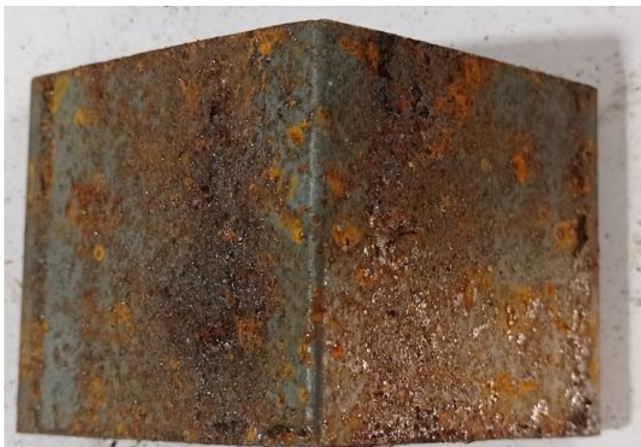
Figura 40. Amostra 4.1 com carepa
