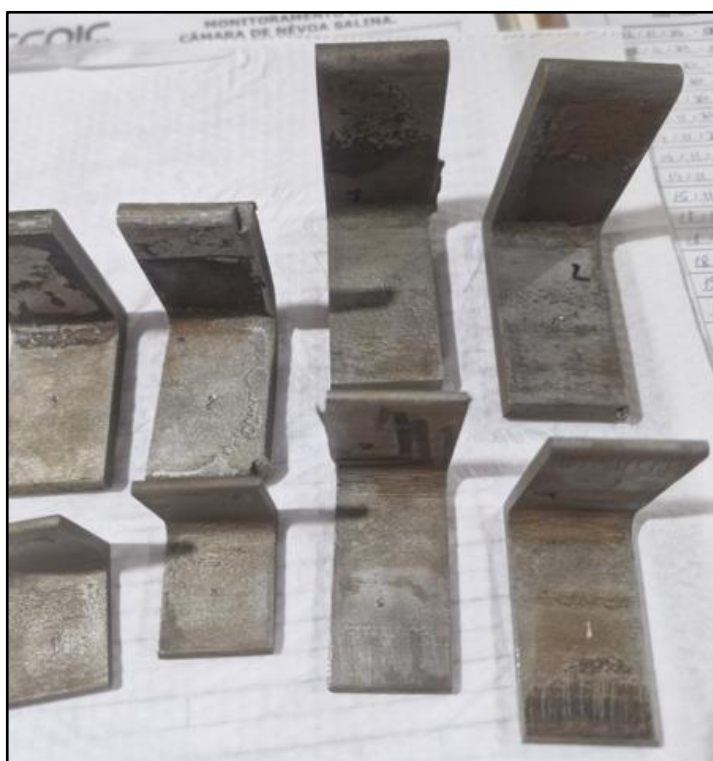
Figura 30. Novas amostras após decapagem química com ácido clorídrico
