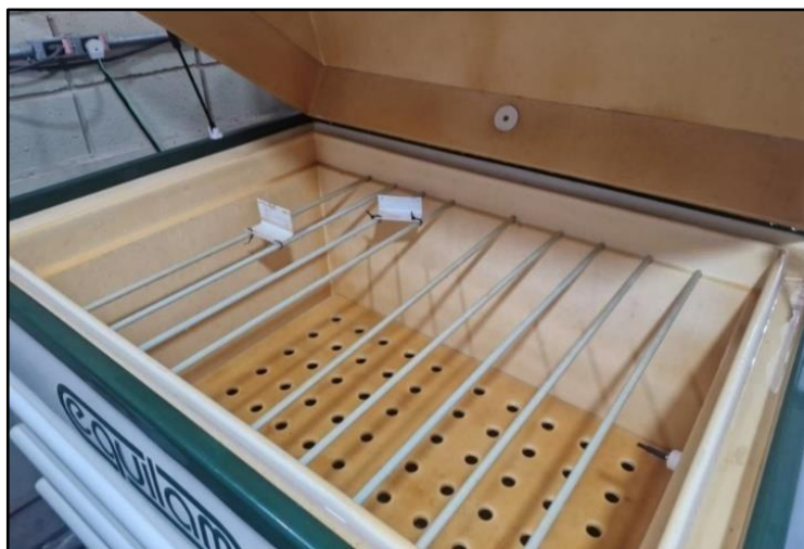
Figura 14. Detalhe do interior do equipamento de ensaio de câmara úmida
