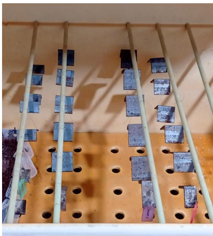
Figura 36. Visão geral dos corpos de prova após 226 dias de ensaio (13/05/25)
