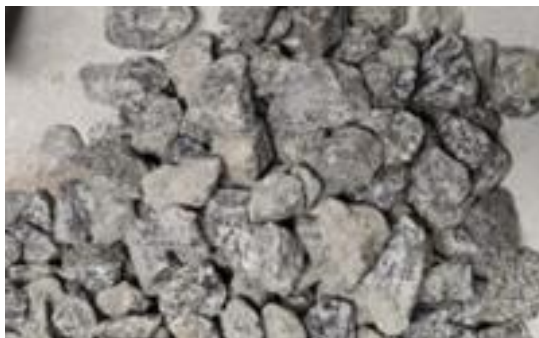
Figura 3. Brita 1 com granulometria entre 9,5 mm a 19 mm.
