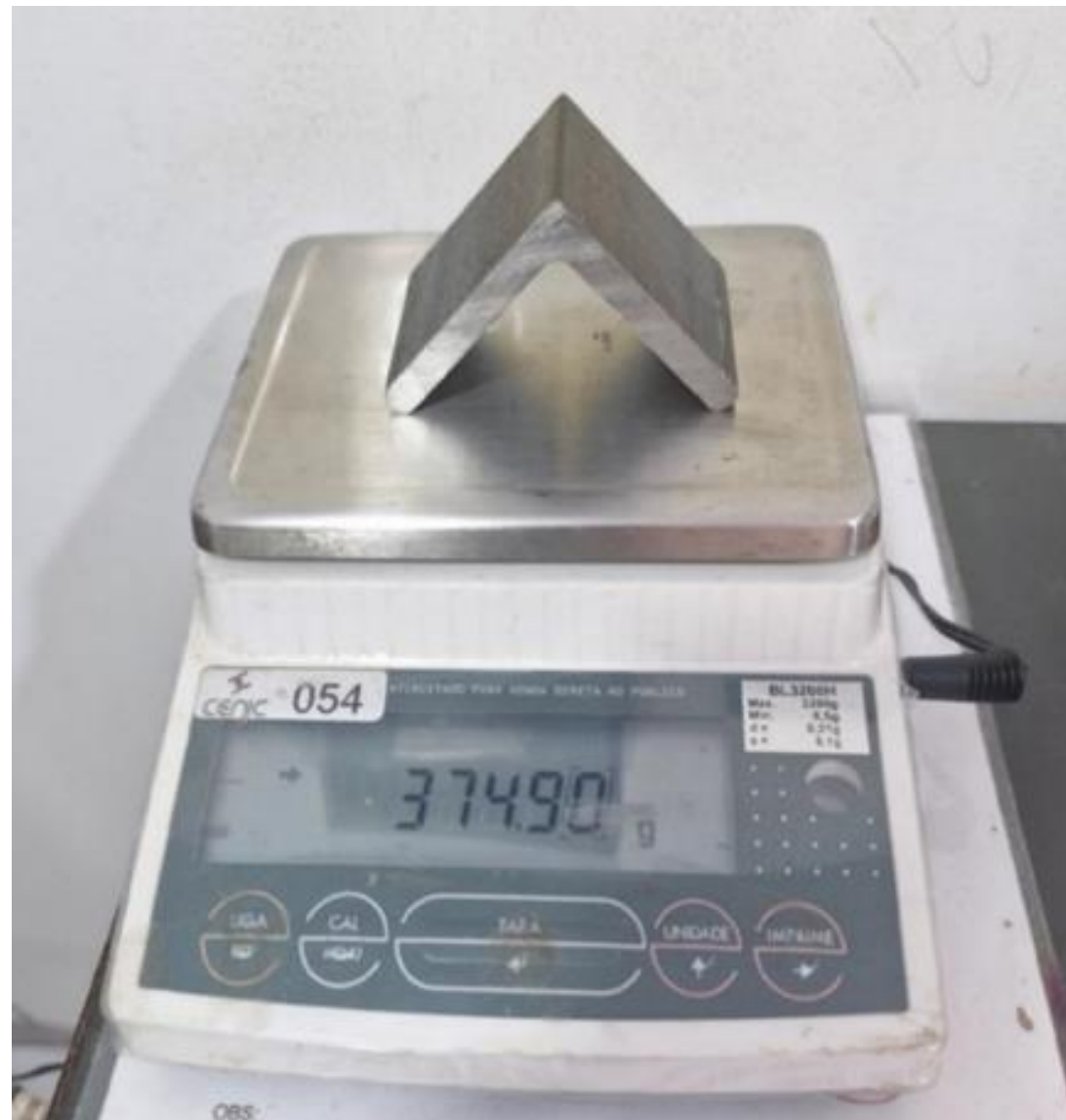
Pesagem dos corpos de prova
