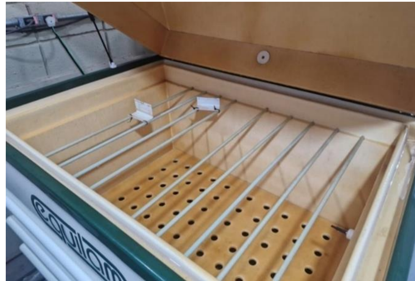
Detalhe do interior do equipamento - Câmara úmida
