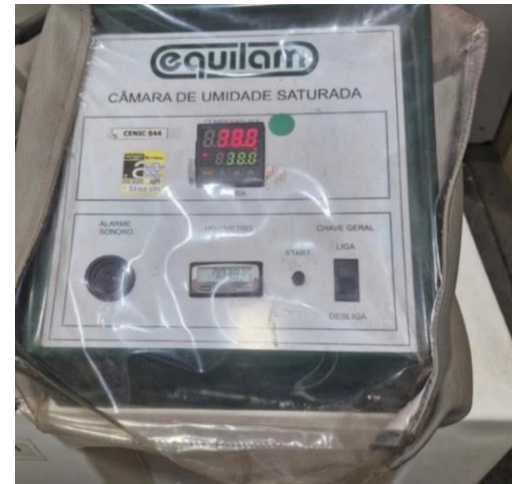
Detalhe do controle de temperatura do equipamento - Câmara úmida
