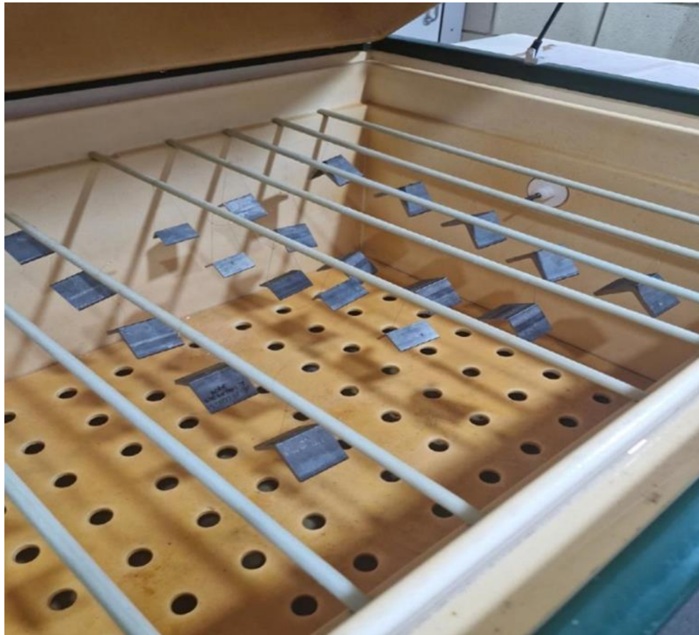
Corpos de prova distribuídos dentro do equipamento de ensaio de câmara úmida
