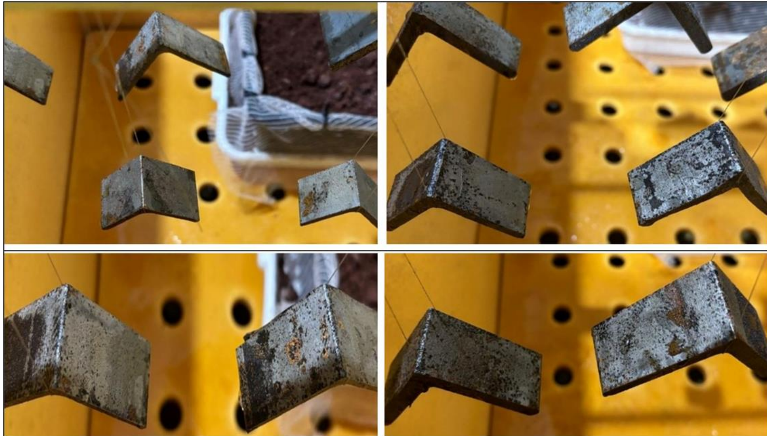
Detalhe dos corpos de prova decapados após 4 dias de ensaio
