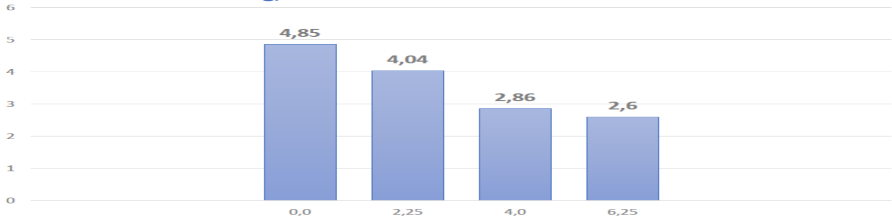
Fck 25 MPa aos 7 dias: Coeficiente de Variação com 0,0, 2,25, 4,0 e 6,25 kg/m 3 de Macrofibra Sintética no Concreto
