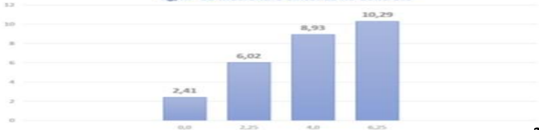
Fck 40 MPa aos 28 dias: Coeficiente de Variação com 0,0, 2,25, 4,0 e 6,25 kg/m 3 de Macrofibra Sintética no Concreto
