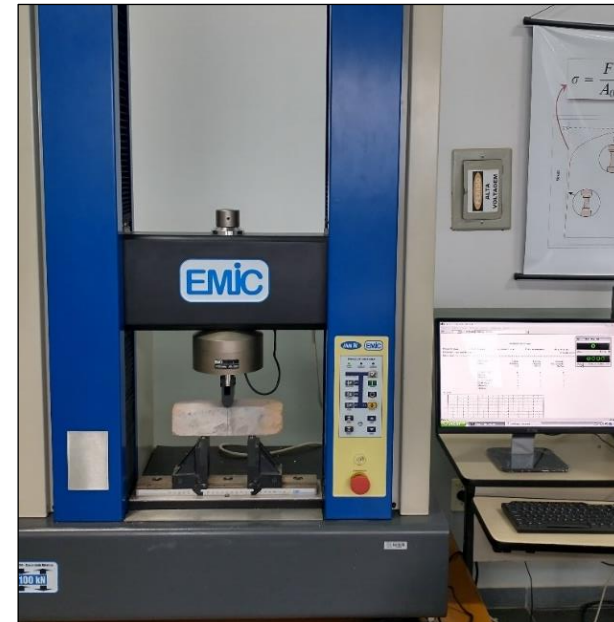
Máquina de ensaios EMIC linha DL
