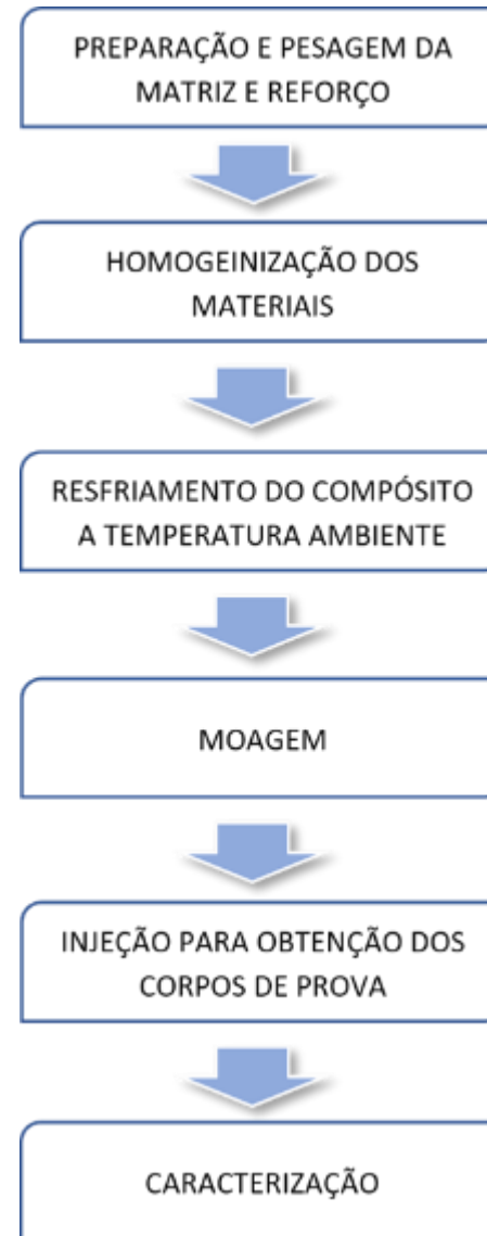
Imagem 8 : Fluxo para produção dos corpos de prova do compósito
