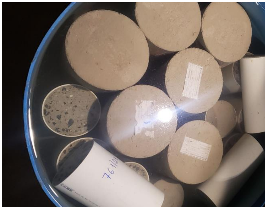
Figura 7. Corpos de prova submersos em água.
