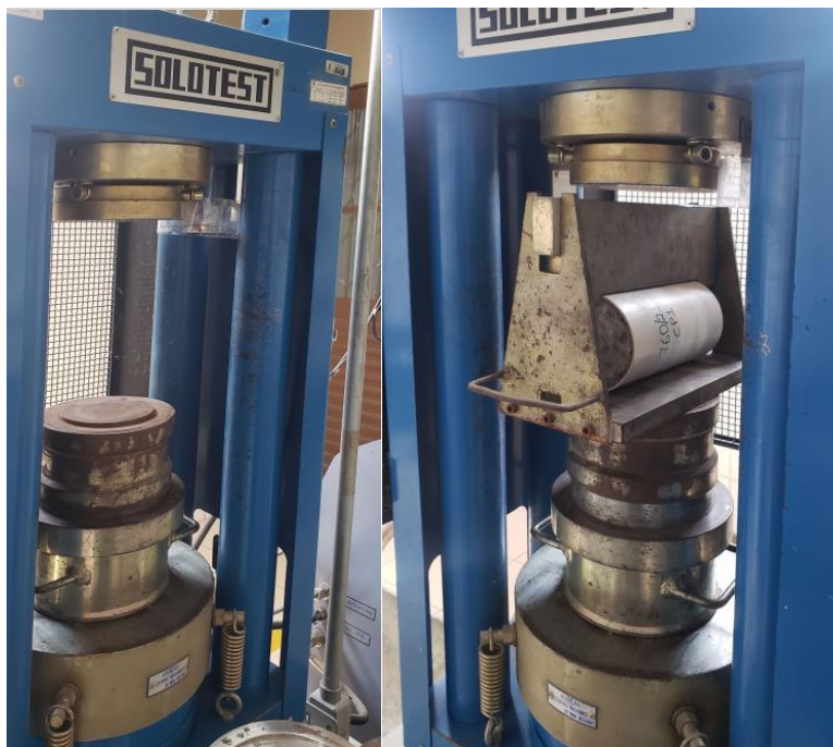
Figura 8. Prensa hidráulica e rompimento na diametral.
