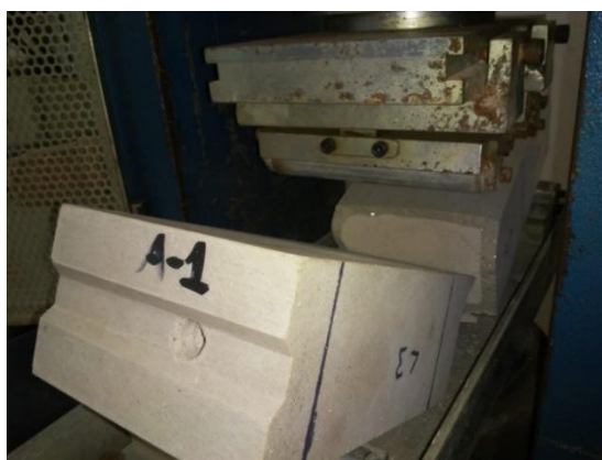
Figura 19. Rompimento do corpo de prova – tração na flexão
