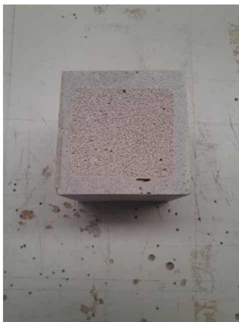
Figura 11. Corpo de prova – compressão
