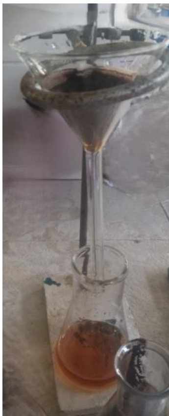
Figura 9: Processo de lavagem da biomassa para retirada dos materiais lignocelulósicos.
