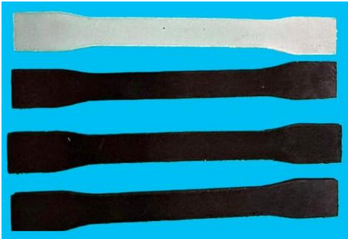
Figura 27: Corpos de prova de tração com 0%, 10%, 20% e 30% m/m de reforço (respectivamente da esquerda para a direita) de biomassa.
