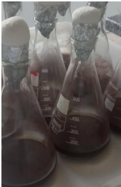
Figura 8: Erlenmeyer com amostra na proporção de 1:10 (m/m) de biomassa e água destilada.
