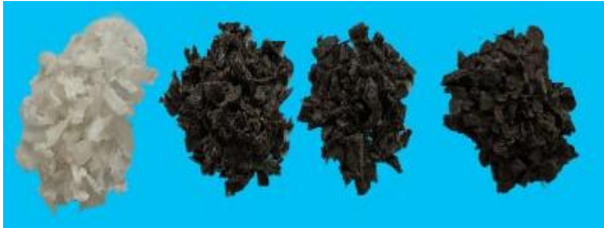
Figura 26: Compósitos in natura após triturados no moinho de facas com 0%, 10%, 20% e 30% m/m de reforço (respectivamente da esquerda para a direita).
