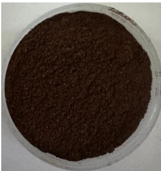
Figura 14: Casca da Castanha do Pará após a segunda moagem e peneirada com tamanho de partícula inferior a 50#.
