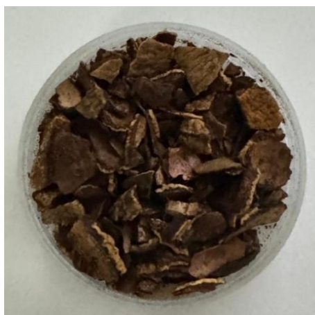
Figura 13: Casca da Castanha do Pará após a primeira moagem.
