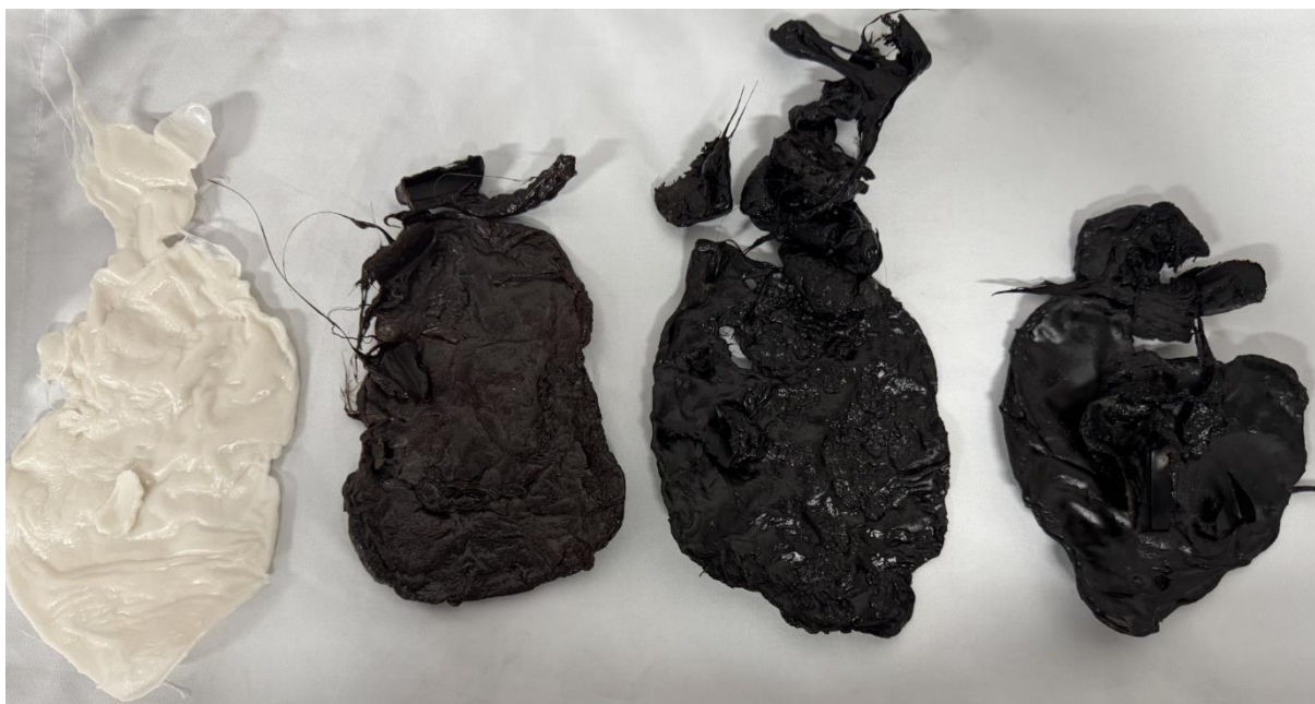
Figura 25: Família de compósitos com 0%, 10%, 20% e 30% m/m de reforço (respectivamente da esquerda para a direita)
