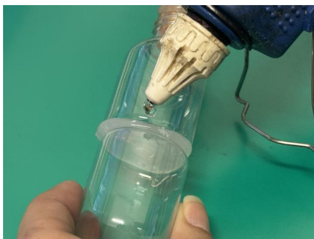
Figura 25: Junção dos recipientes flutuantes com cola quente.
