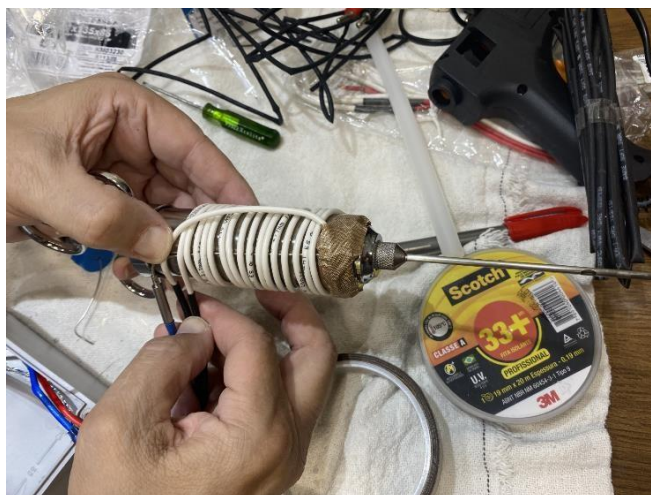
Figura 17: Enrolamento da resistência e posicionamento do termopar no corpo da seringa
