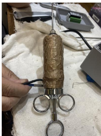
Figura 18: Isolamento do sistema com fita térmica de teflon
