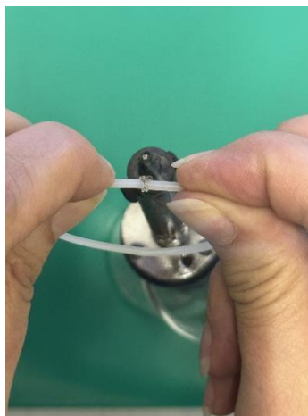
Figura 23: Solda a quente dos filamentos de PEAD.
