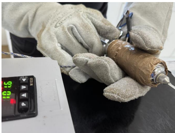
Figura 30: Formação dos fios de PEAD pelo processo de injeção
