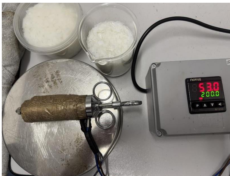
Figura 21: Preenchimento do recipiente de armazenagem da injetora
