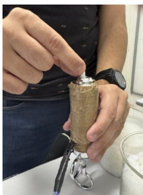
Figura 20: Preenchimento do recipiente de armazenagem da injetora
