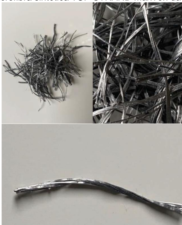
Figura 4. Macrofibra sintética TUF-STRAND MaxTen da marca Viapol.
