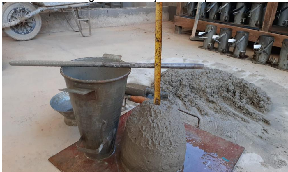
Figura 8. Realização do Slump .
