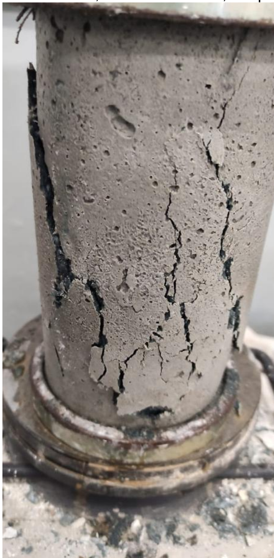
Figura 11. Prensa EMIC, modelo PC 150C, rompendo um CP.
