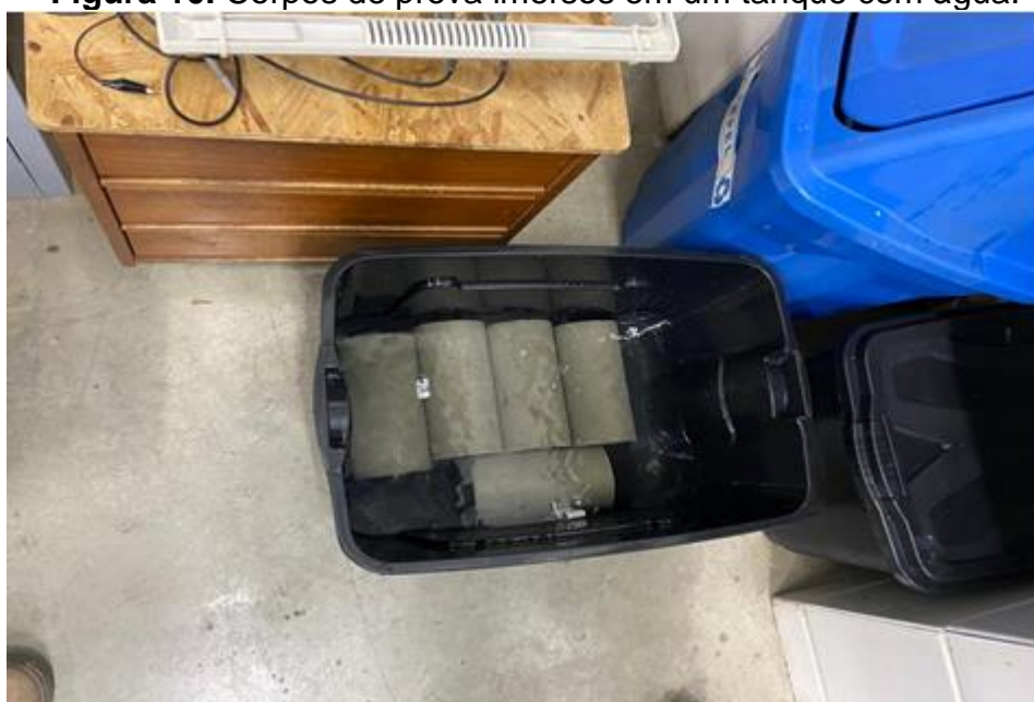
Figura 10. Corpos de prova imersos em um tanque com água.
