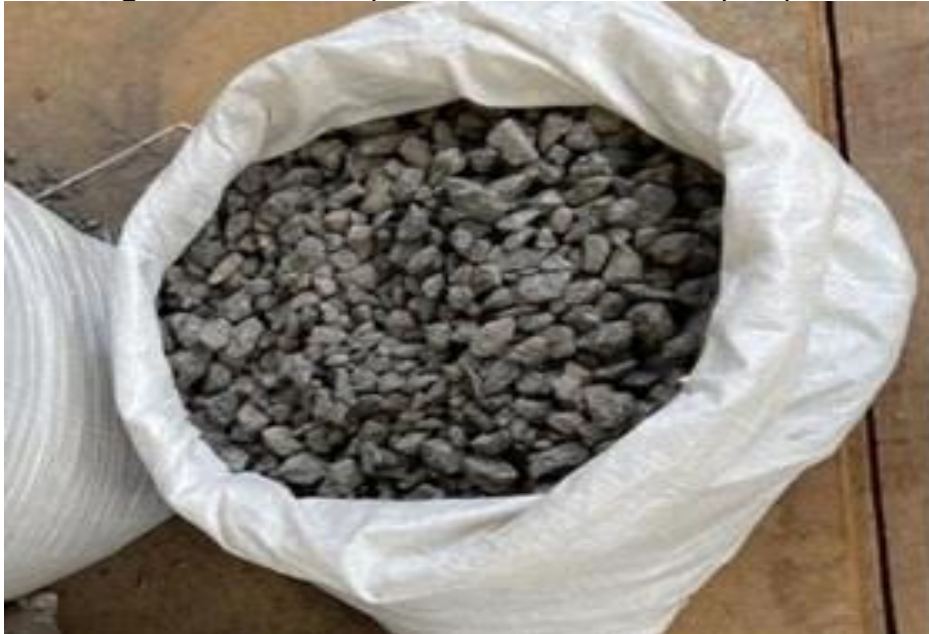
Figura 3: Brita composta no concreto desta pesquisa.
