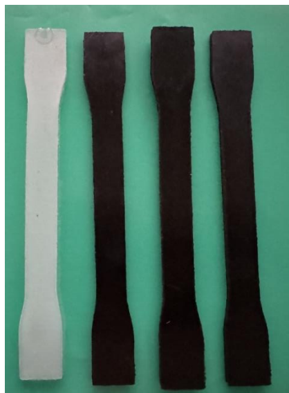
Figura 21: Corpos de prova de tração com 0%, 10%, 20% e 30% m/m (respectivamente da esquerda para a direita) de biomassa.
