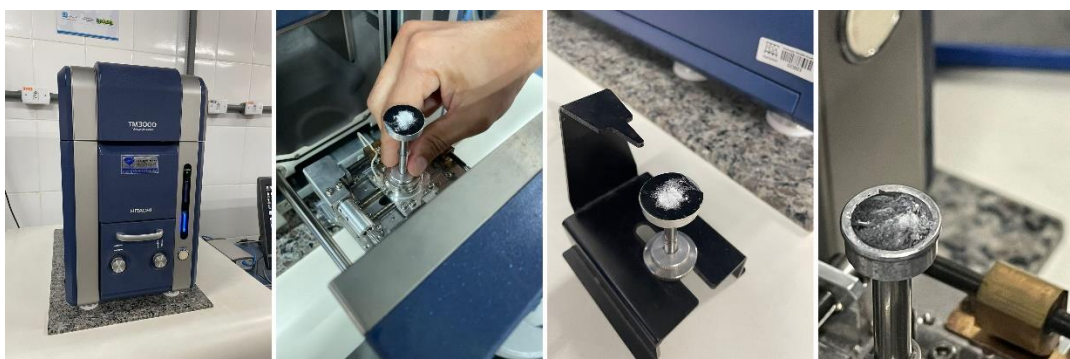
Figura 8. imagens da utilização do microscópio eletrônico de varredura (MEV)
