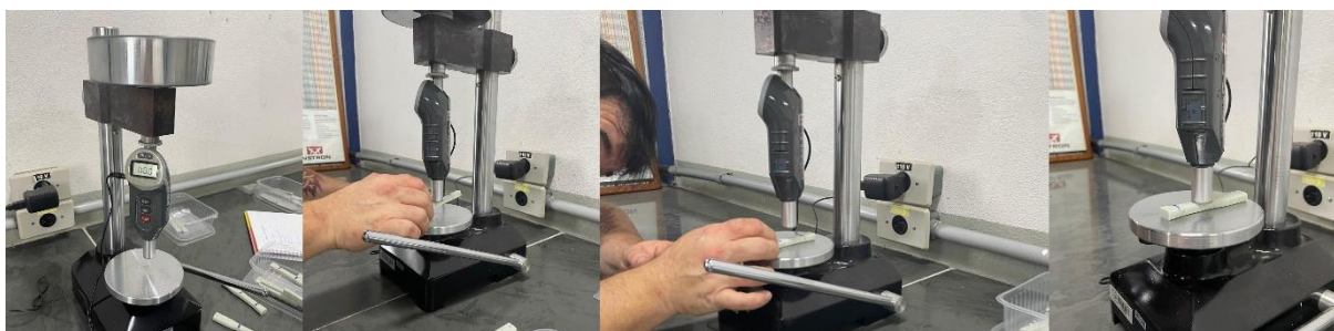
Figura 19. imagens do ensaio de dureza shore D.
