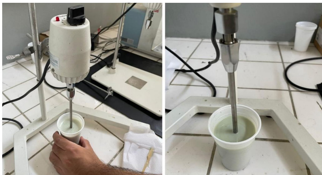
Figura 12. imagens da mistura da resina com pó de espinélio
