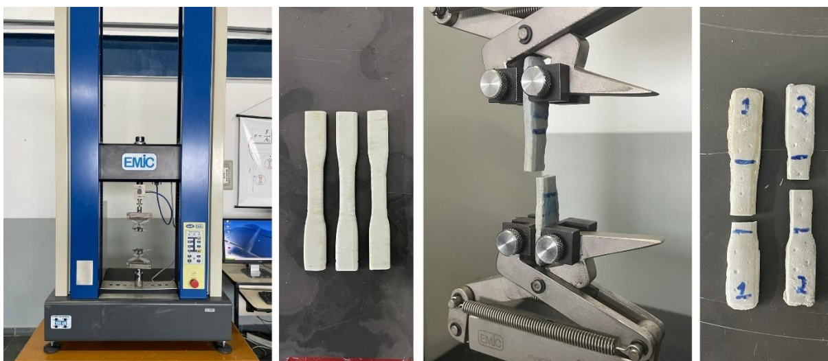
Figura 17. imagens do ensaio de tração.
