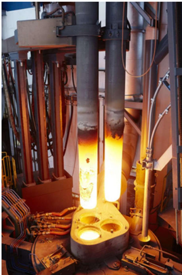
Figura 9. Lança refratária de dessulfuração.
