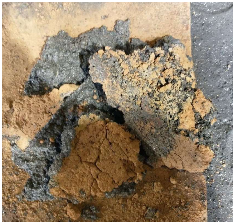
Figura 48. Material projetado com cascão após limpeza
