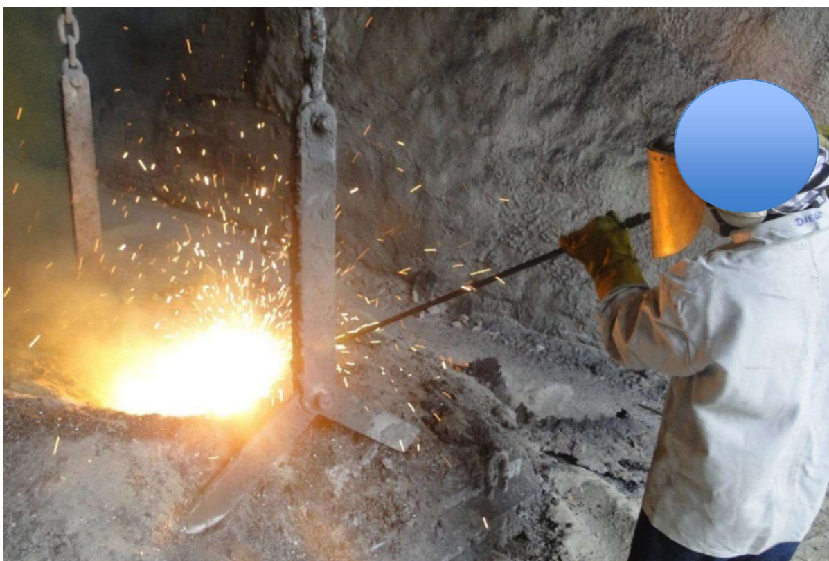
Figura 27. Limpeza da tampa com O 2 utilizando a vara de Oxiflame
