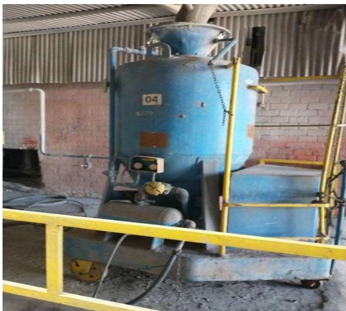
Figura 23. Máquina de projeção de concreto refratário
