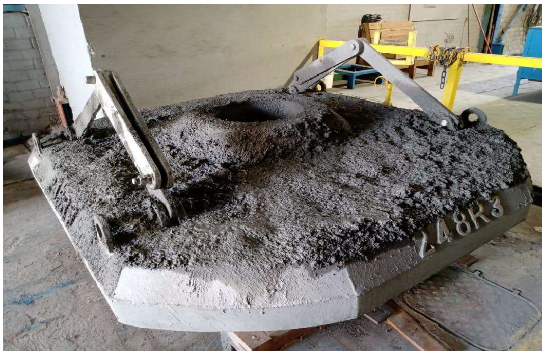
Figura 25. Concreto refratário aplicado com 30 mm de espessura
