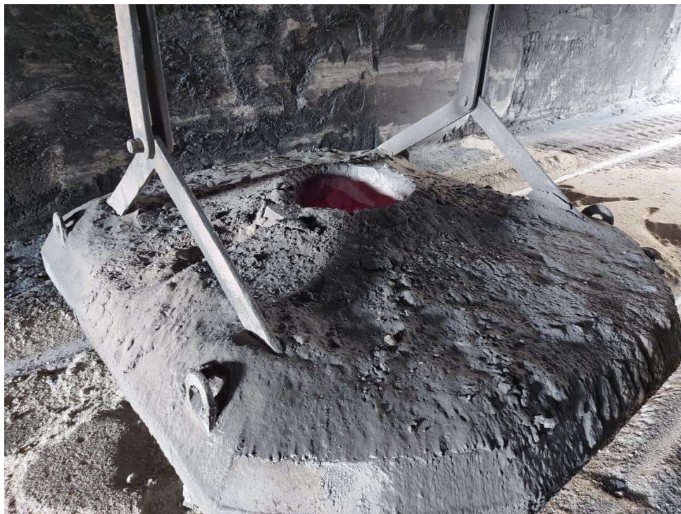
Figura 51. Tapa refrataria após 8 horas de operação
