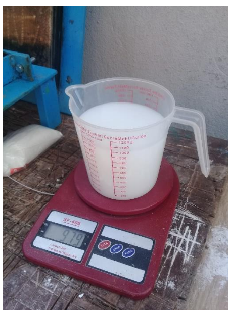
Figura 22- Mistura dos componentes para obtenção da resina ureia-formaldeído
