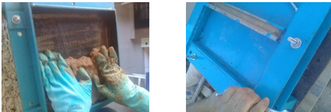
Figura 8- Preparação dos corpos de prova para formação de placas
