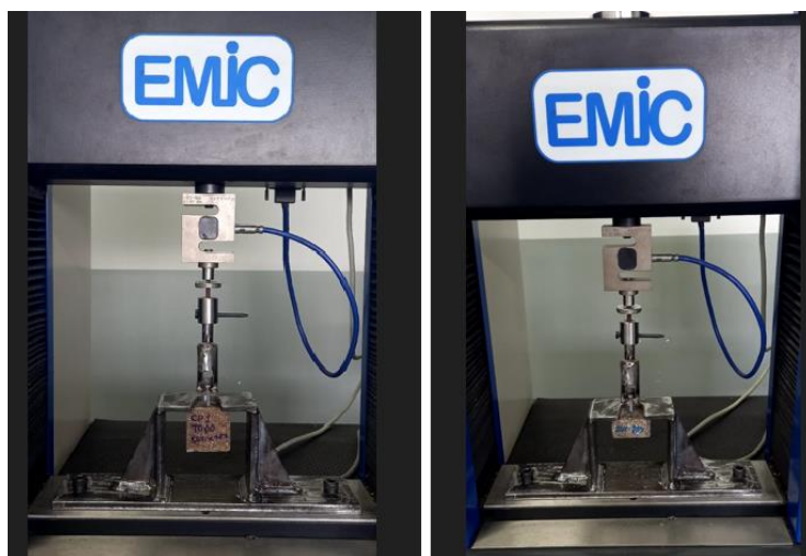
Figura 13- Montagem do ensaio de resistência ao parafuso no equipamento de ensaio mecânico universal modelo EMIC- DL1000
