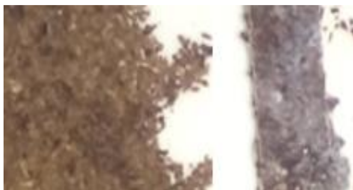
Figura 27- Aspecto do compósito, após curado, obtido com a fibra tratada
