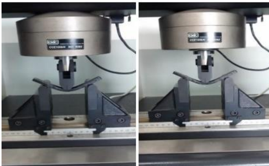
Figura 17- Ensaio de flexão em três pontos - EMIC- DL10000
