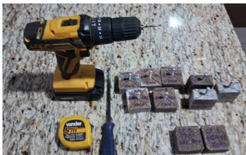
Figura 14- Preparação dos corpos de prova para o ensaio de resistência ao arrancamento do parafuso
