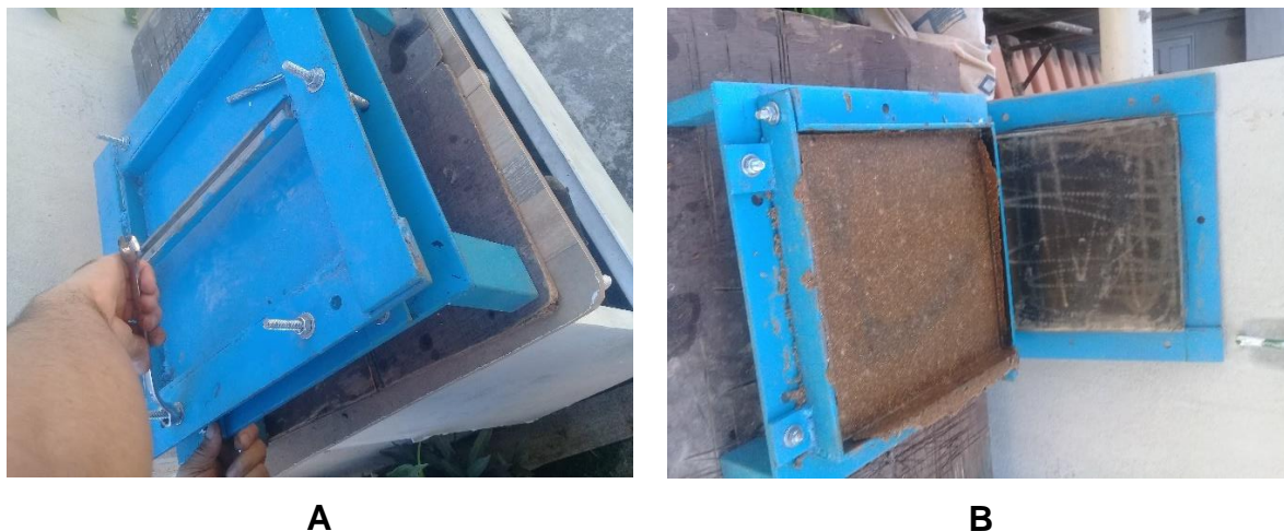
Figura 9- Processo de desenformar os corpos de prova para formação de placas
