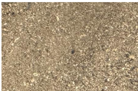
Figura 19- Porção contendo o material retido em 100 meshes e fundo
