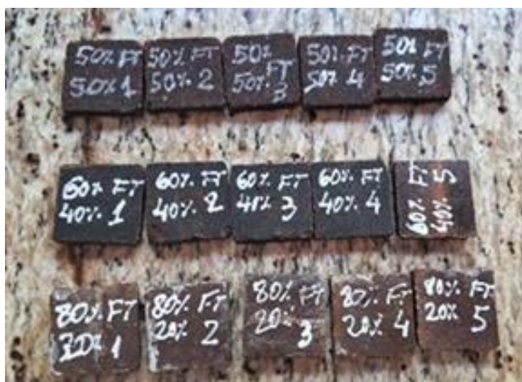
Figura 10- Corpos de prova utilizados para determinação de umidade
