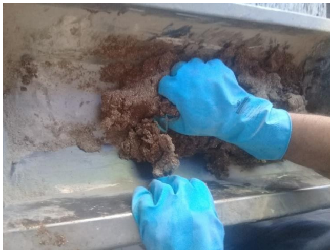
Figura 7- Mistura manual dos materiais para obtenção dos compósitos
