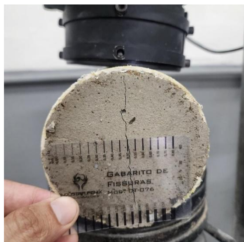
Figura 5. Teste de compressão axial com controle de fissuras.
