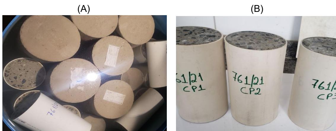
Figura 3. Moldagem dos corpos de prova: (a) Corpos de provas imersos; e (b) Corpos de provas na capa de PVC.
