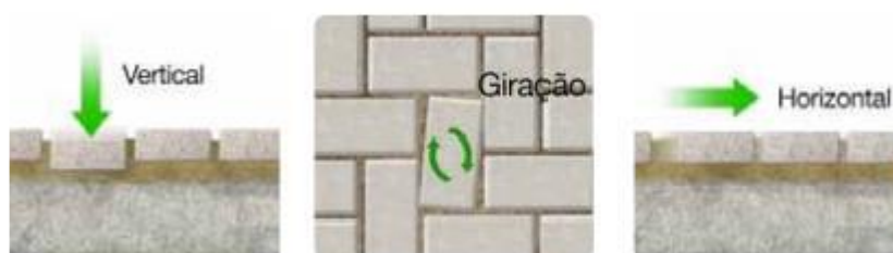
Figura 14: Funcionalidade do Intertravamento
