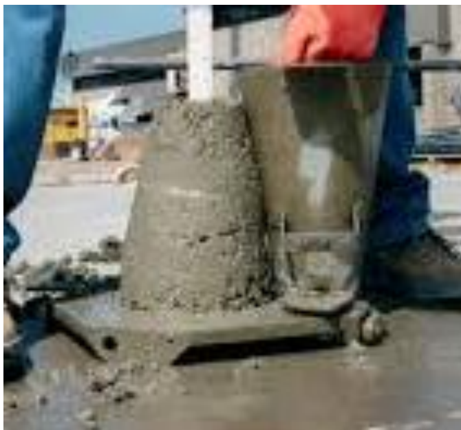
Figura 25: Teste Slump para aferição da fluidez.
