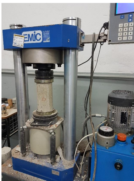
Figura 26: Ensaio de resistência à compressão axial
