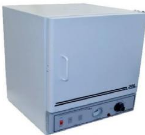
Figura 27: Estufa de esterilização marca Odontobrás modelo EL 1.5
