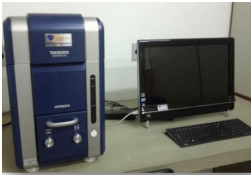
Figura 28: Microscópio Eletrônico de Varredura Hitachi MEV–TM 3000
