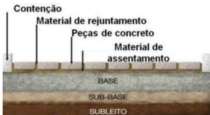
Figura 13: Estrutura do pavimento flexível
