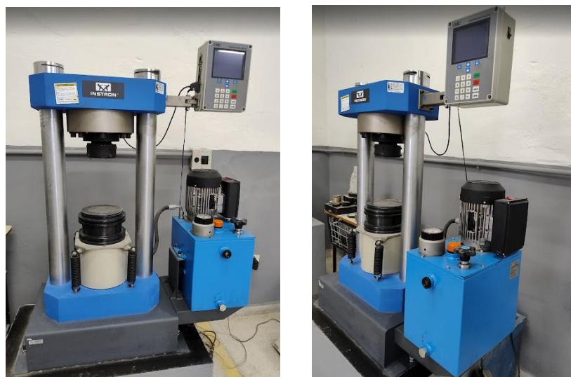
Figura 13: Prensa hidráulica usada para a realização dos ensaios
