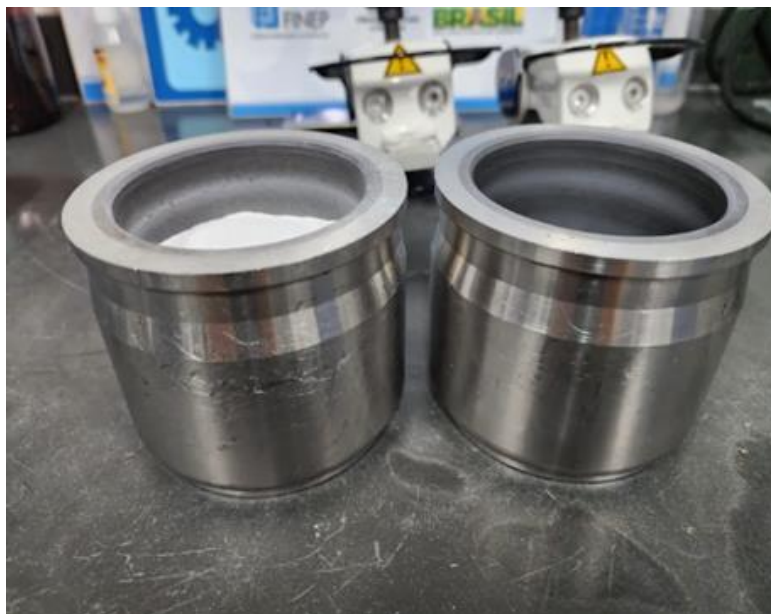
Figura 5. Zircônia e ácido esteárico no moinho de bolas.
