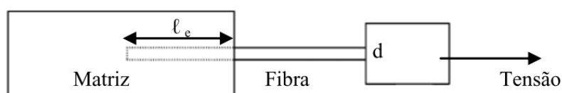
Figura 13 - Representação ensaio de pull - out
