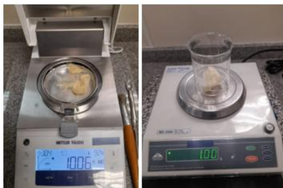
Figura 30 - Ensaio de umidade, utilizando balança de infravermelho
