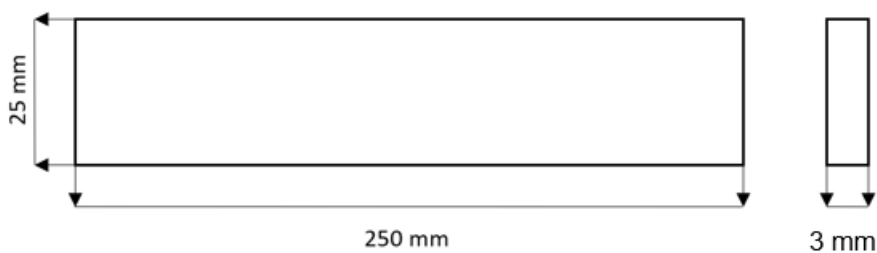
Figura 36 - Corpo de prova conforme dimensão ASTM D3039
