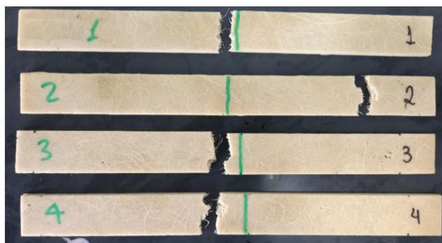
Figura 37 - Fratura do corpo de prova para caracterização morfológica
