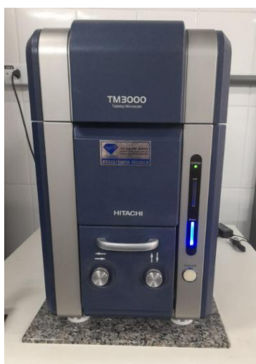
Figura 31 - Microscópio eletrônico de varredura - MEV
