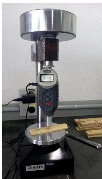
Figura 40 - Ensaio de dureza Shore D
