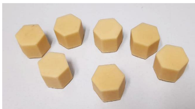
Figura 23 - Corpo de prova PU formato hexagonal
