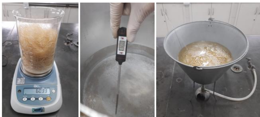
Figura 19 - Processo de lavagem da fibra de sisal
