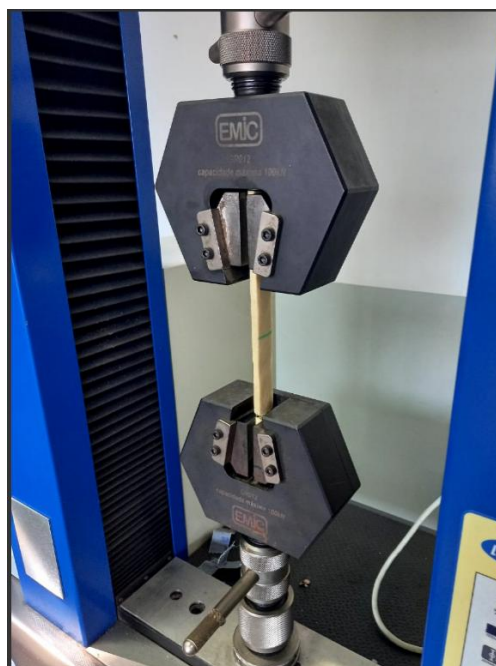
Figura 35 - Ensaio de tração compósito ASTM D3039
