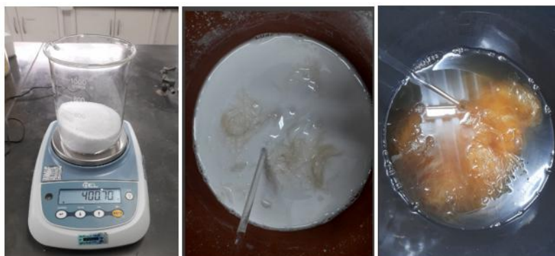
Figura 20 - Processo de mercerização da fibra
