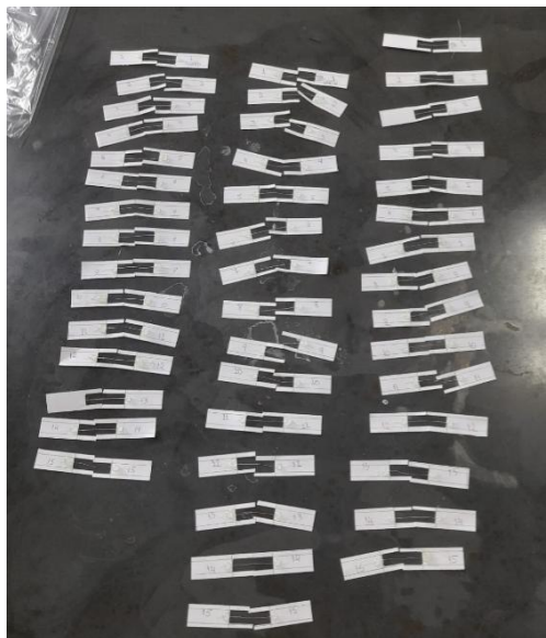
Figura 34 - Amostras para ensaio de tração conforme norma ASTM D3379-75
