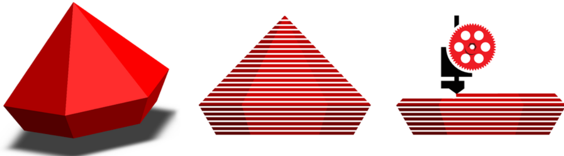
Figura 9 - Representação das principais etapas do processo de impressão camada por camada.
