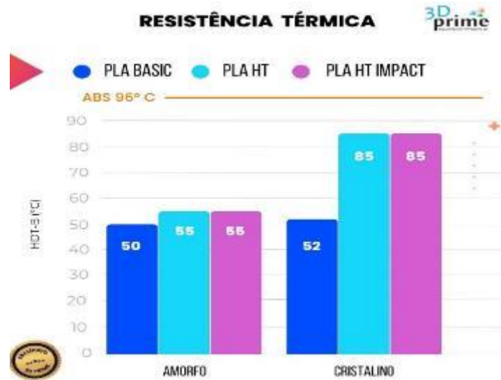
Figura 11 - Comparativo resistência térmicas entre ABS, PLA, PLA HT Impact
