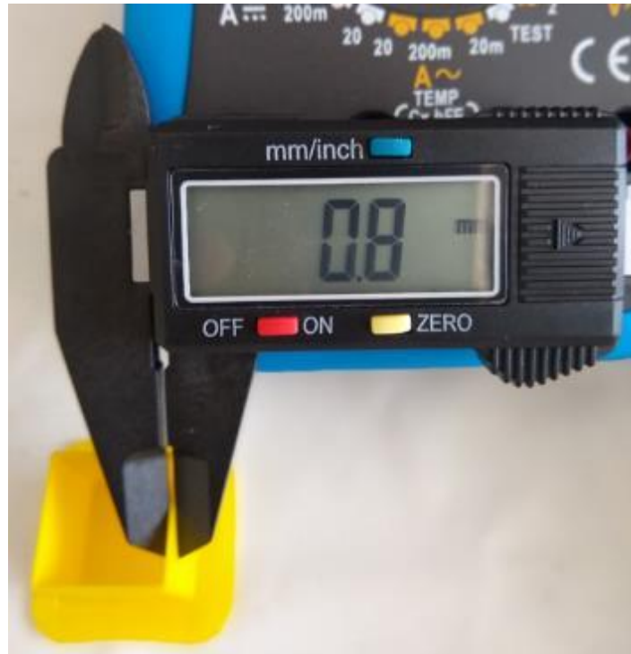
Figura 75 - Verificação parede do cubo (taxa de extrusão)
