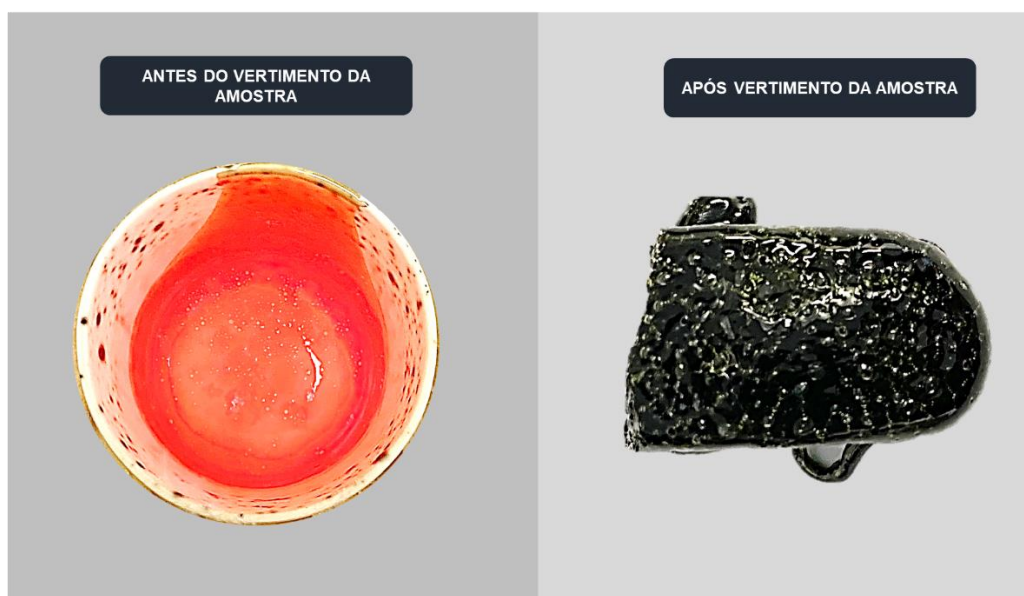
Figura 6. Inspeção Visual – Ocorrência de Bolhas
