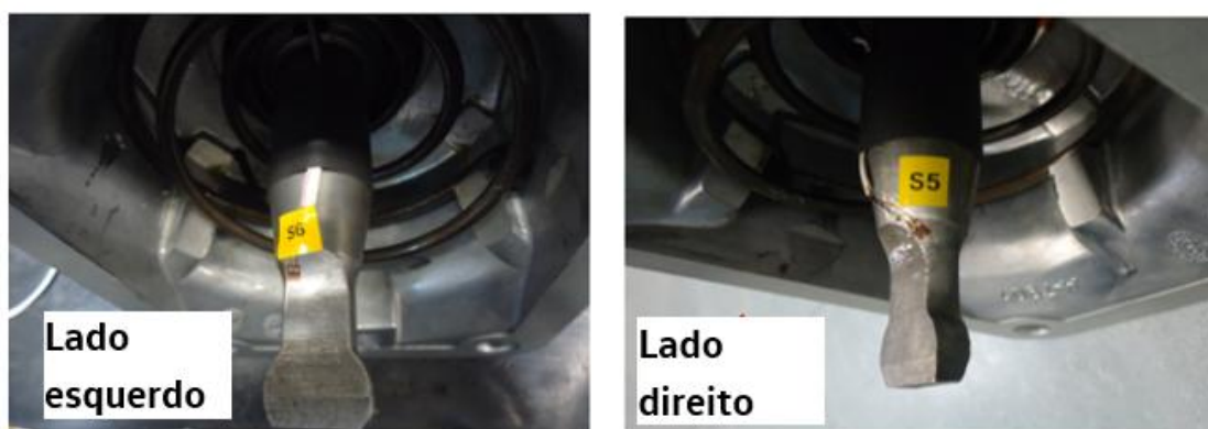
Figura 60: Extensômetros no finger da transmissão.
