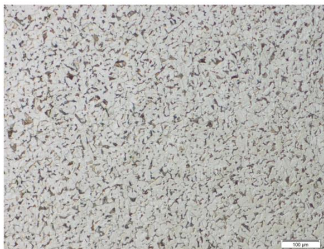
Figura 75: Microestrutura do metal base da peça final – Ataque nital 3%. Aumento 100X.
