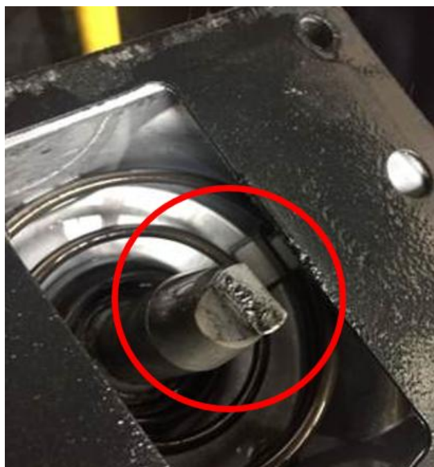
Figura 58: Finger da transmissão fraturado com 893 ciclos.
