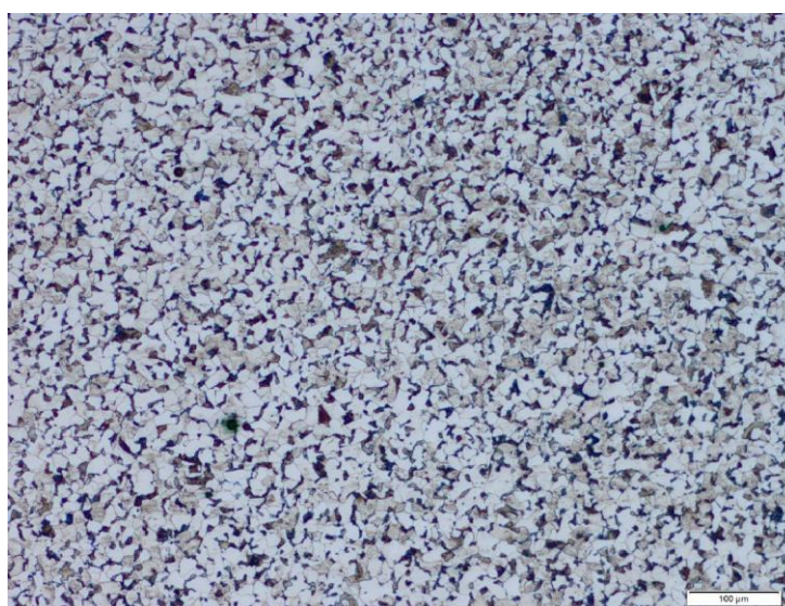
Figura 69: Microestrutura do metal base – Ataque nital 3%. Aumento 100X.
