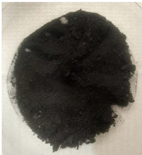
Figura 10: Material após lixiviação pronto para ser ativado.
