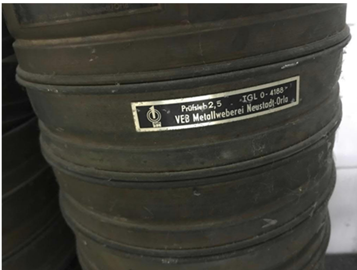
Figura 7: Peneira, marca VEB Metallweberei Neustadt-Orla, 2,5 mm.
