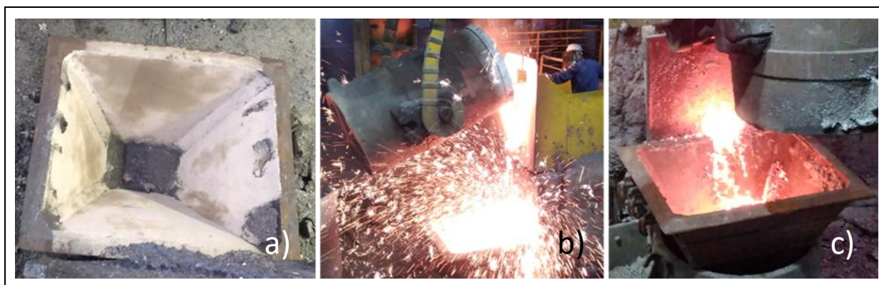
Figura 27 – Fotos Pote no posto de escorificação, esquimagem.
