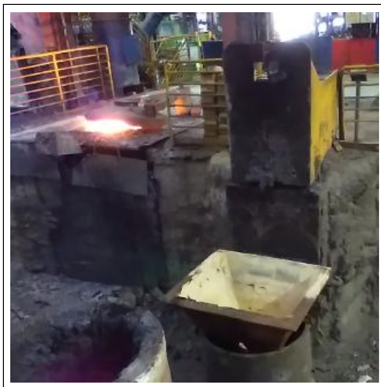
Figura 23 – Foto posto de escorificação – Escumação.
