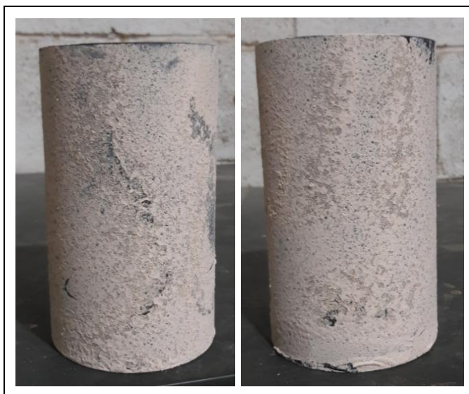
Figura 12 - Teste de sopro de Ar direto na superfície pintada - Bico de Ar comprimido Pressão – 5 Bar.
