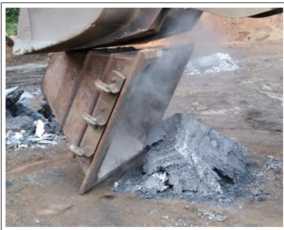
Figura 29 – Foto limpeza do pote por basculamento, descarte da escória.
