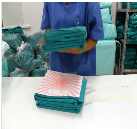
Figura 16: Pacote desafio Bowie Dick a) Coloração rosa, original da folha; b) Posicionamento da folha no centro do pacote
