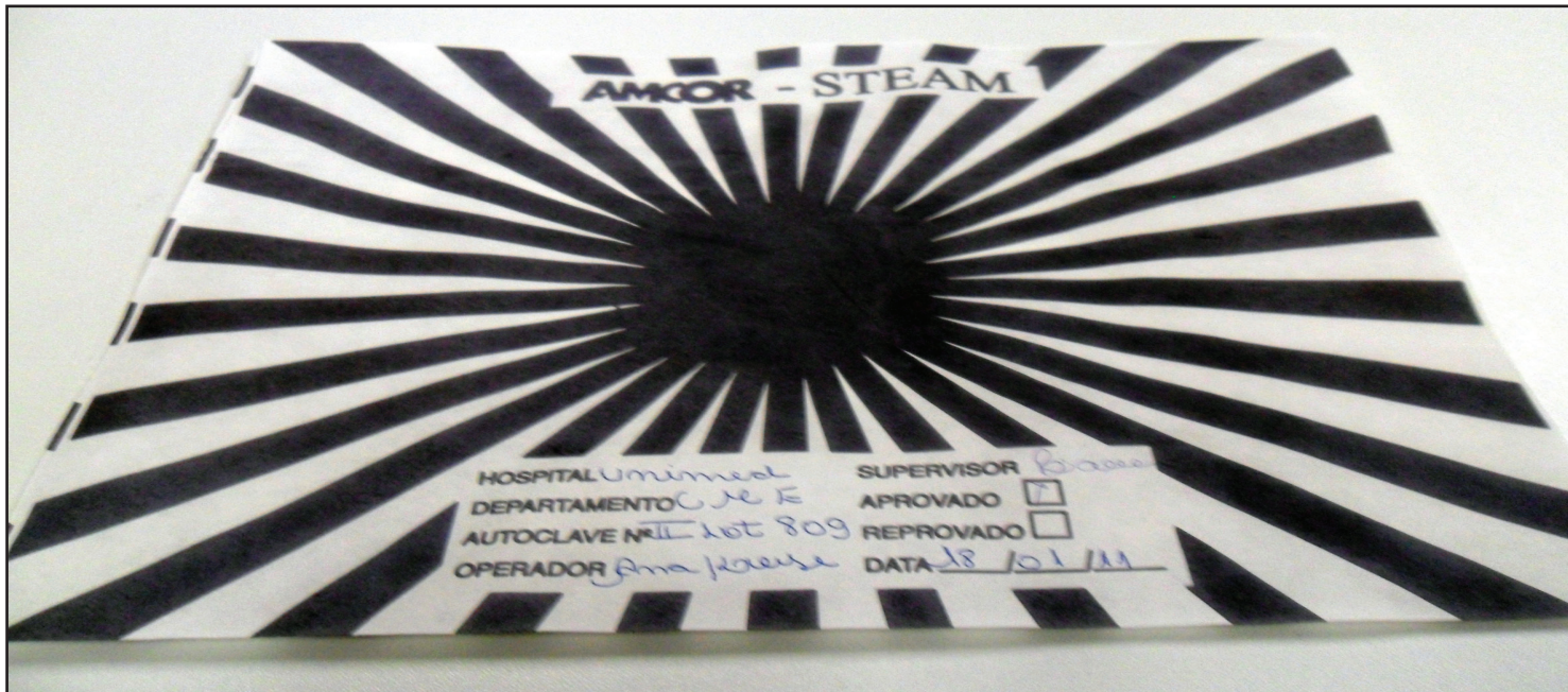
Figura 18: Teste Bowie Dick após processamento em autoclave
