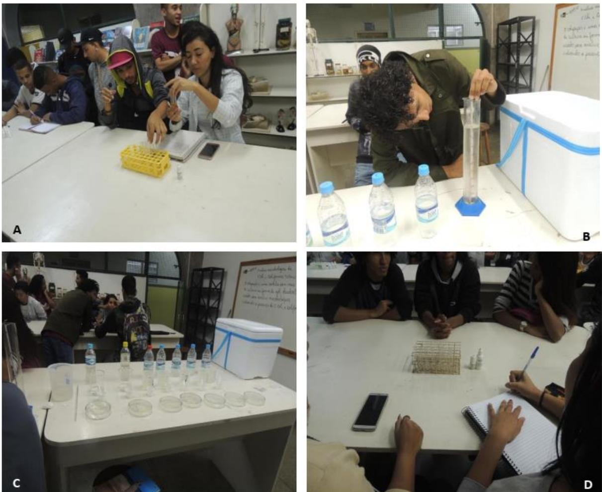
A – Alunos realizando as análises de amônia. B - Alunos realizando o ensaio de turbidez da água. C – Alunos realizando a preparação para análise de microbiologia de coliformes fecais estão preparando para colocar na estufa a 36 °C. D – Alunos realizando as análises de fosforo total.
