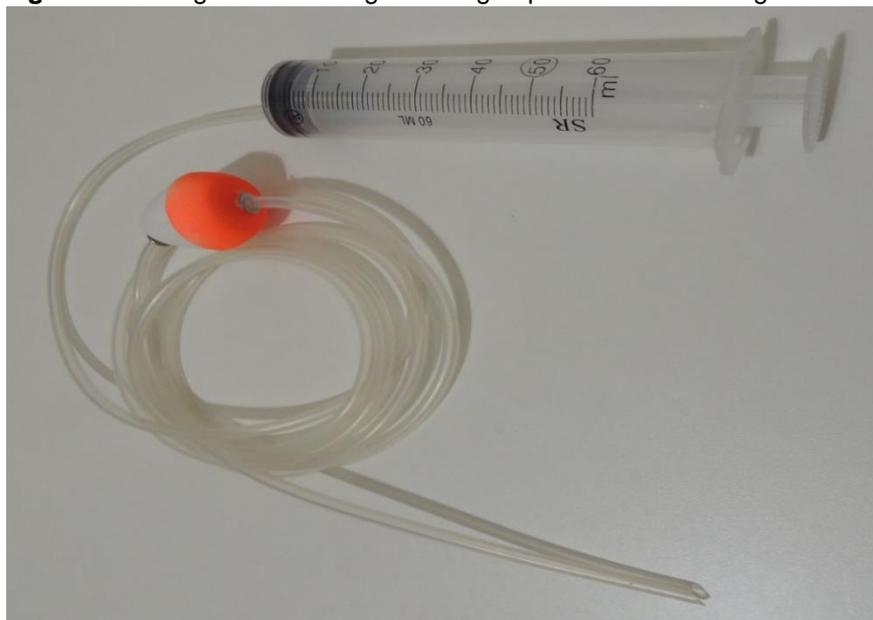
Entre uma amostragem e outra, lavar o tubo de ensaio com água limpa (água mineral) e depois com álcool etílico 70%. O oxigênio dissolvido tem o processo de análise com capacidade de medição de 0,5 a 9,0 mg/l, variando de 0,5; 1,0; 3,0; 5,0; 6,0; 7,0; 8,0 e 9,0 mg/l dos valores possíveis de medição.
