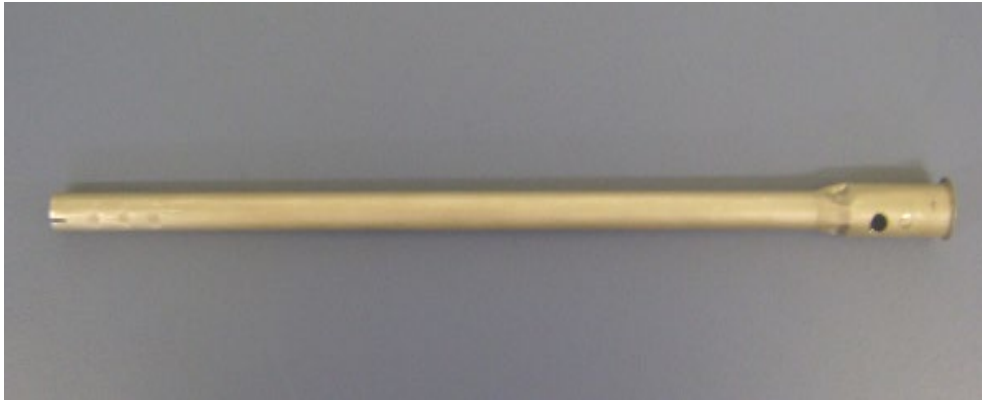
Figura 12 - Cânula com extremidades de diâmetro diferentes
