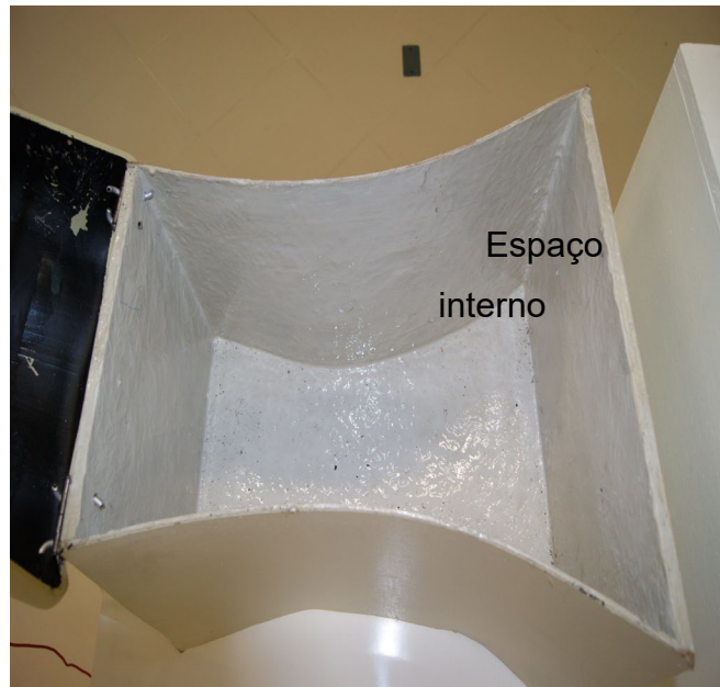
Figura 4 - Parte Interna do Estojo do Manequim com espaço interno de 30 cm de altura
