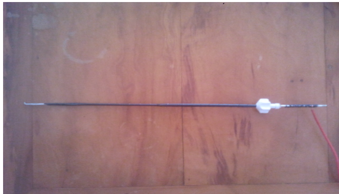
Figura 21 - Confeção da Pinça Hook
