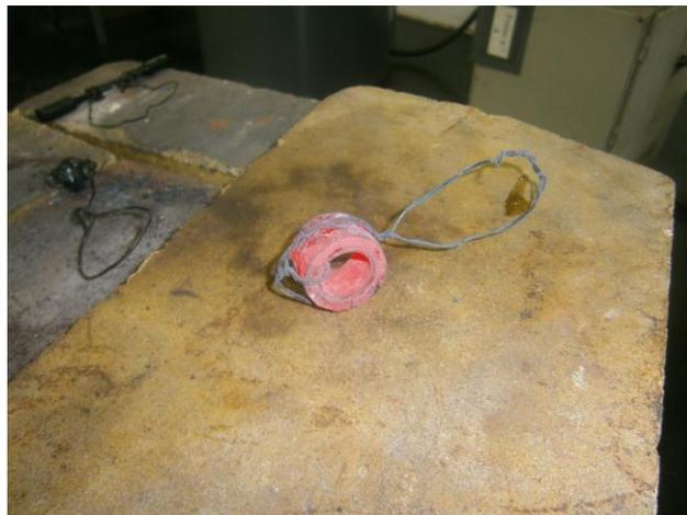
Figura 5.14- Foto da amostra sendo resfriada ao ar (Fonte: o autor)
