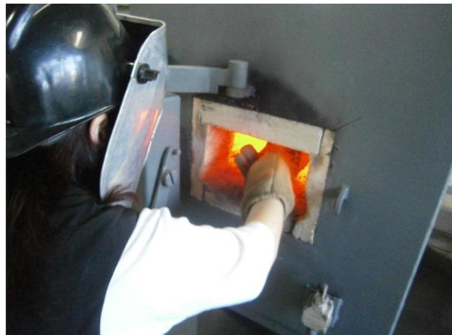
Figura 5.7 – Foto da colocação da amostra no forno (Fonte: o autor)
