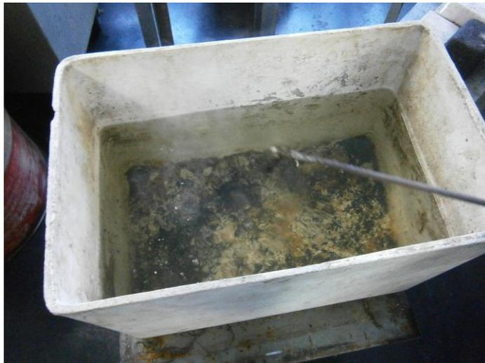
Figura 5.18 – Foto dos vapores do resfriamento da amostra em água (Fonte: o autor)
