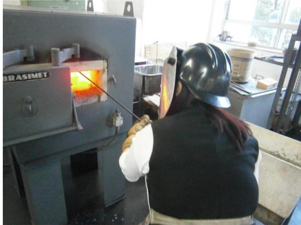
Figura 5.11 – Foto da amostra sendo retirada no forno (Fonte: o autor)
