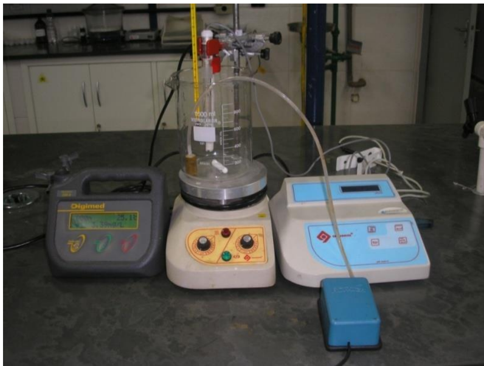
Figura 12 - Respirômetro montado no laboratório do UniFOA. Fonte: Autor
