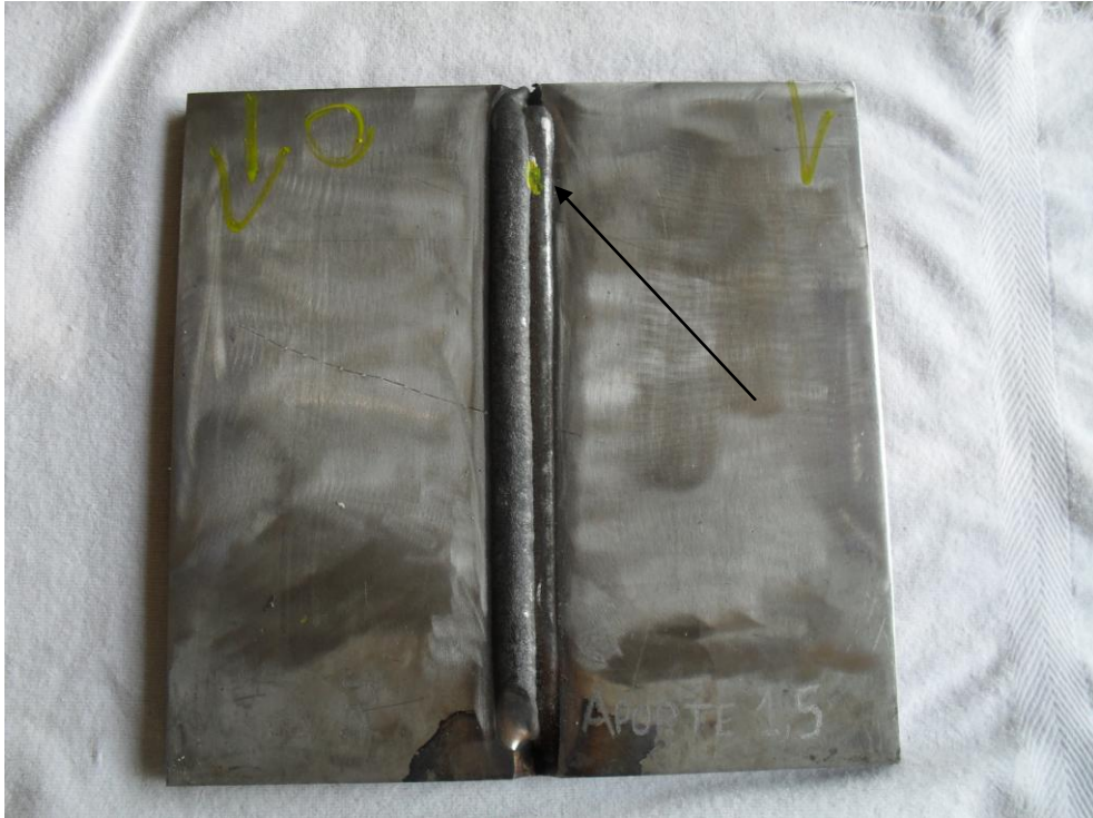
Figura 21 Identificação de falha no cordão de solda amostra A3.
