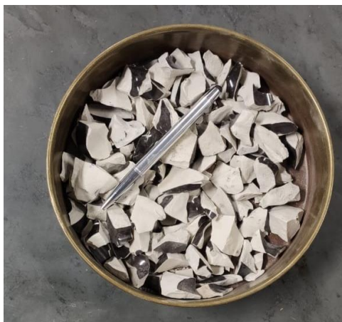
Figura 23. Isoladores Elétricos de Porcelana separados
