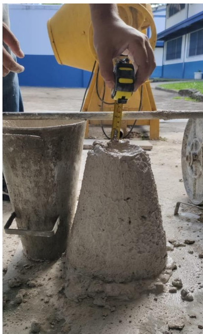
Figura 32. Ensaio de abatimento no concreto Referência.
