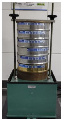
Figura 14. Agitador de peneira SOLOTEST
