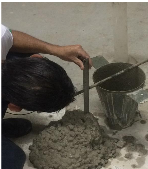
Figura 25 – Medição do abatimento e régua metálica
