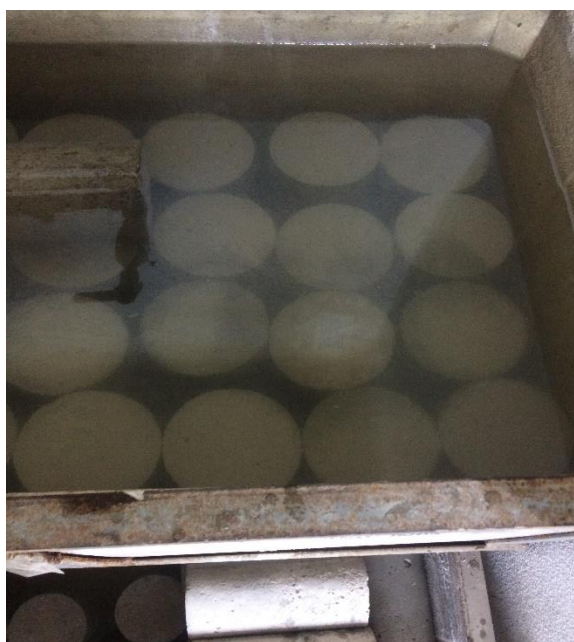
Figura 26 – Tanque de Cura (Câmara úmida)
