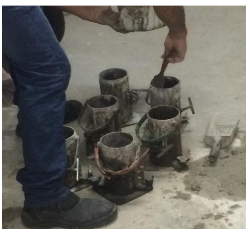
Figura 29 - Revestimento dos Moldes com Óleo
