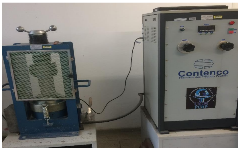
Figura 27 - Prensa Contenco, elétrica digital, 100 toneladas, modelo I-3025-B
