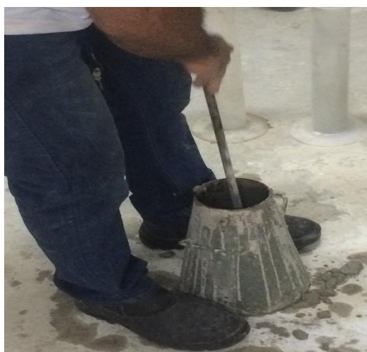
Figura 24 - Cone e barra de aço para o Teste de Slump
