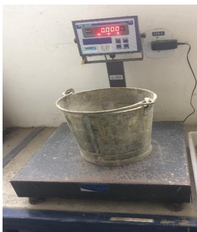
Figura 22 - Balanças de precisão para pesagem do cimento
