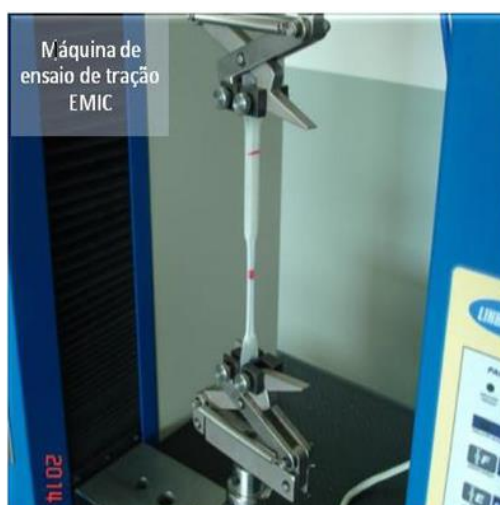
Figura 9: CDP de tração de acordo com a Norma ASTM D638. Nota: Dimensões em mm.
