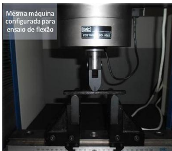
Figura 10: Máquina de ensaio mecânico EMIC.b) Máquina configurada para ensaio de flexão
