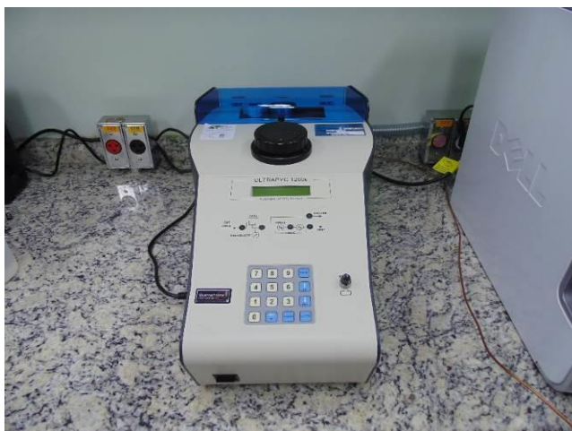
Figura 7 - Analisador de Densidade Real, marca Quantachrome Instruments, modelo UltraFoam 1200e.
