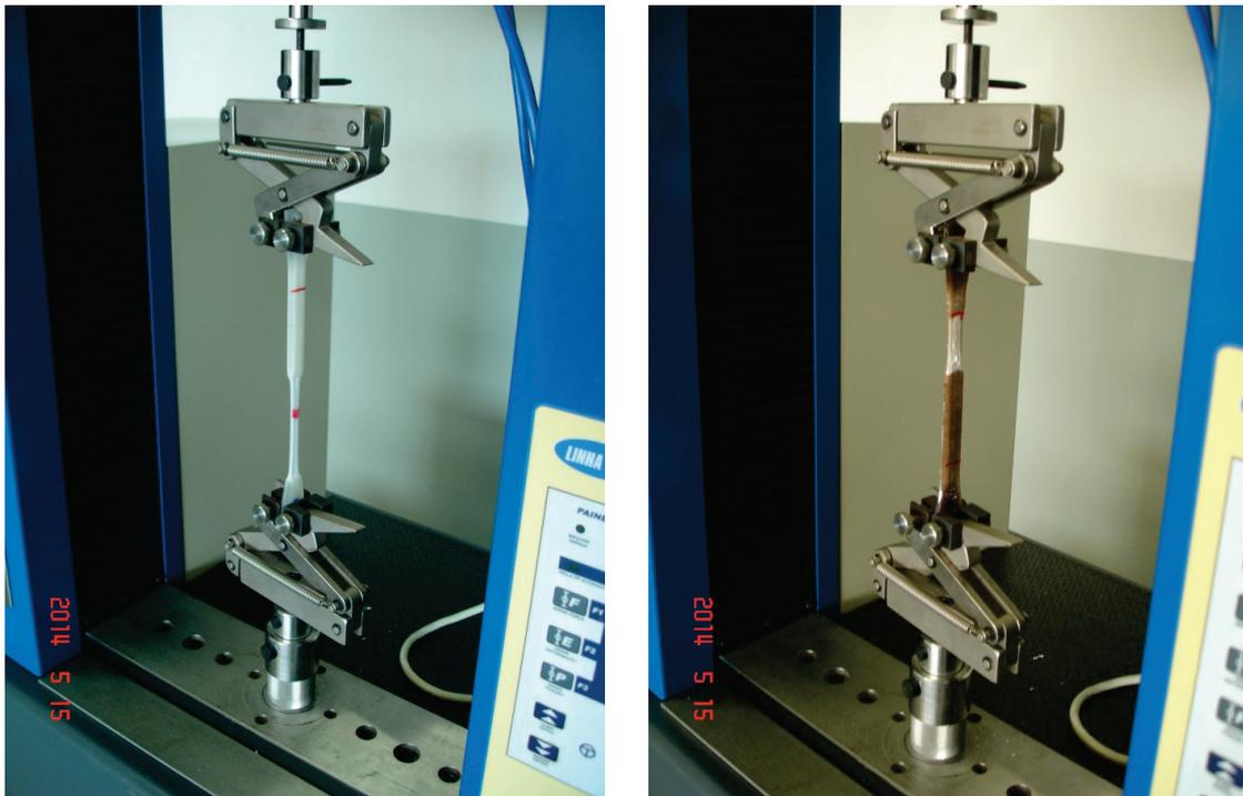
Para cada compósito avaliado, foram ensaiados cinco corpos de prova com dimensões de acordo com a norma ASTM D 638 – 03. O formato e as dimensões em milímetros dos corpos de prova utilizados estão indicados na Figura 13.
