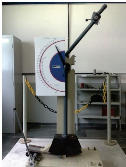
Foram analisados cinco corpos de prova, com dimensões de acordo com a norma ASTM D 6110 – 05 corpos de prova com 12 mm de largura, 55 mm de comprimento e 6 mm de espessura. Foram avaliadas a energia absorvida ao impacto e a resistência.
