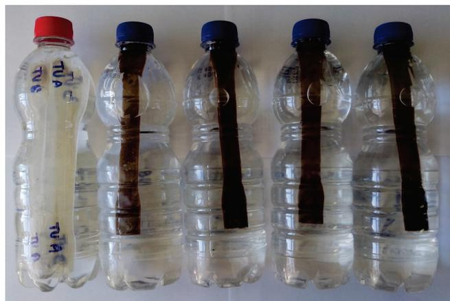
Para avaliar a influência da absorção de água nos compósitos sobre a resistência dos mesmos foi realizado ensaio de tração após o estudo.
