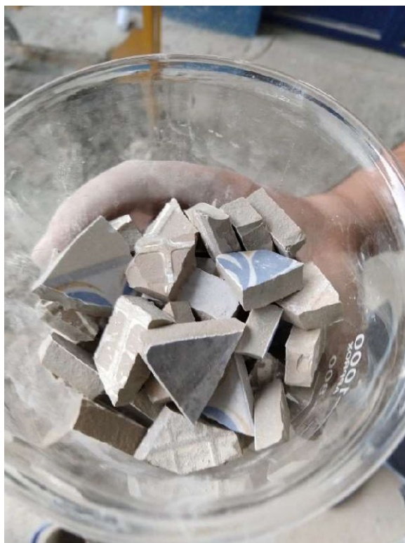
Figura 9. Cacos de porcelanato utilizados no presente trabalho (Fonte: Autoria própria)
