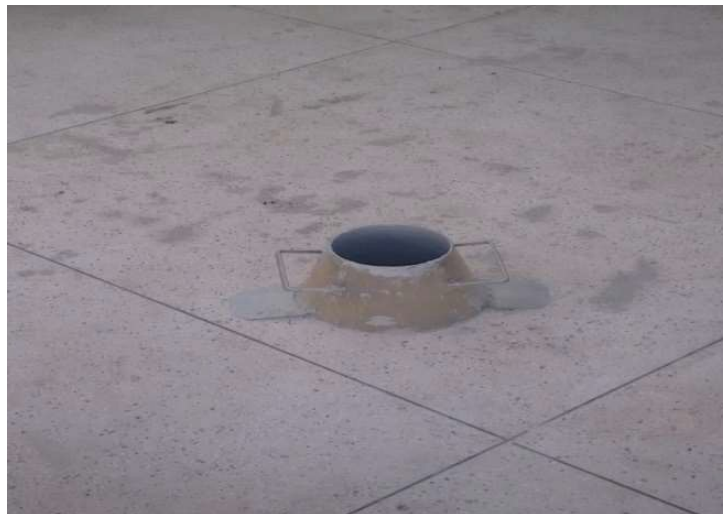
Figura 11. Cone de Abrams para Slump Test (SILVA, 2017).
