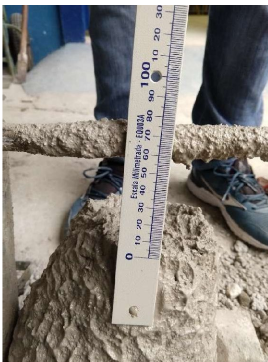
Figura 12. Imagem da medição do Slump Test (Fonte: Autoria própria)
