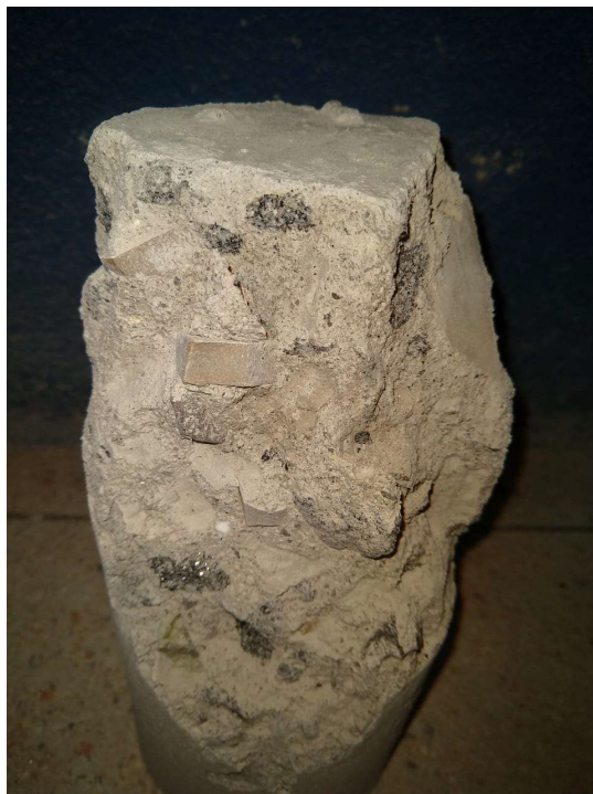
Figura 14. Corpo de prova após o ensaio de compressão (Fonte: Autoria própria)
