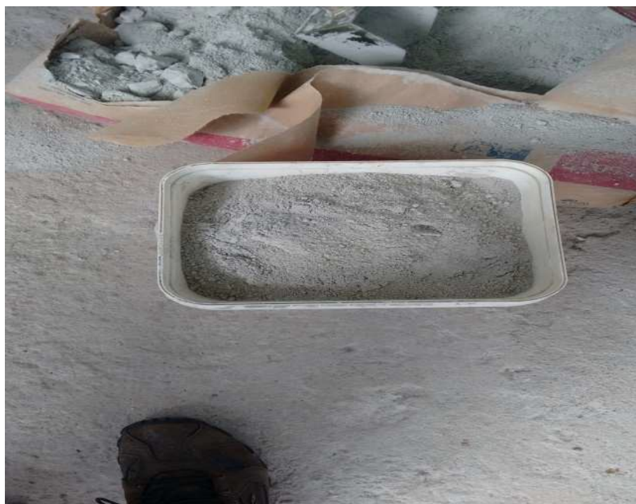
Figura 7. Cimento Portland CPIII utilizado como material no presente trabalho (SILVA, 2017).
