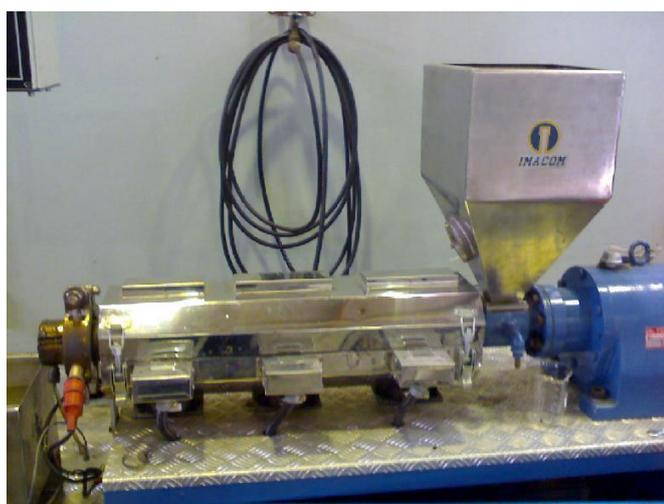
Figura 3.3 Extrusora usada para obtenção do protótipo.
