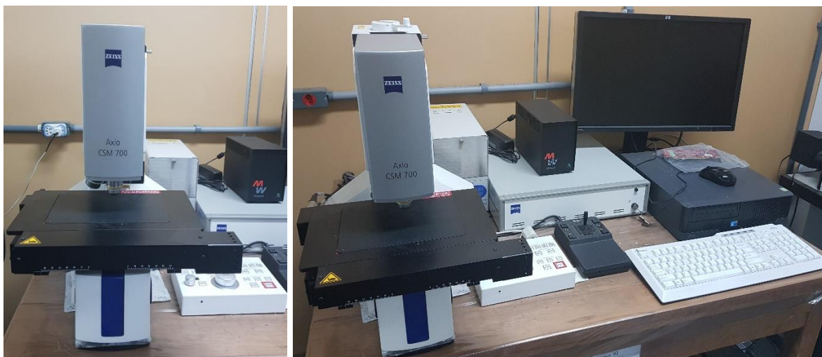
Figura 26: Microscópio Confocal com aumento de 110X.
