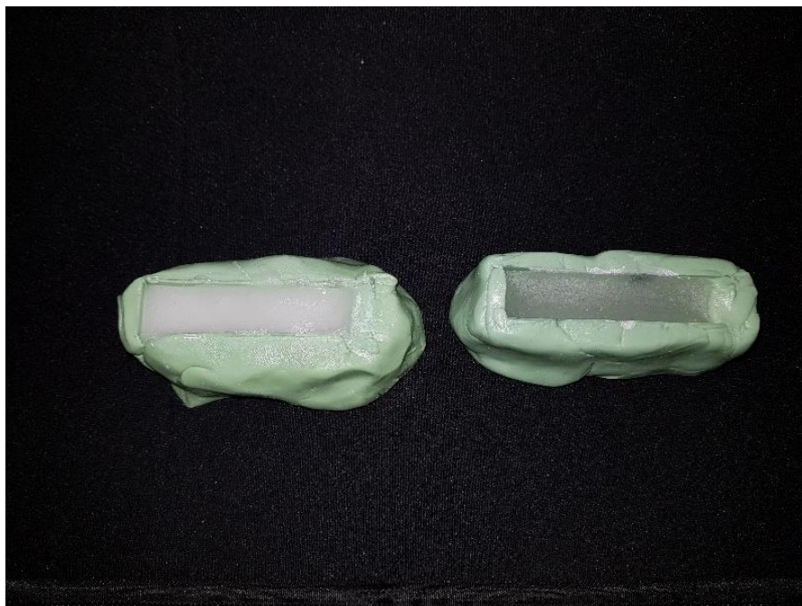
Figura 8: Confeção dos blocos em resina para preparo dos modelos mestres.
