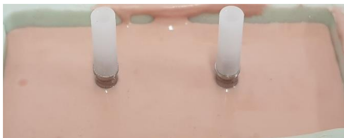
Figura 5: Gesso especial Tipo IV vertido dentro do molde.
