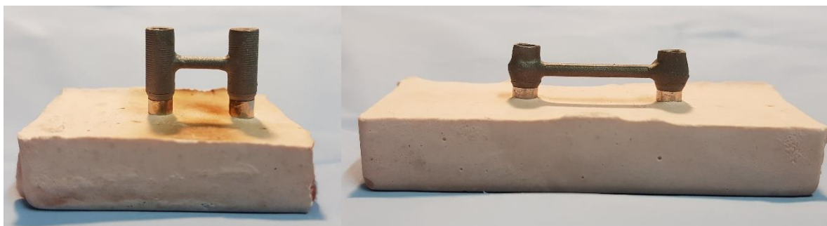
Figura 6: Estruturas fundidas sobre os respectivos modelos.
