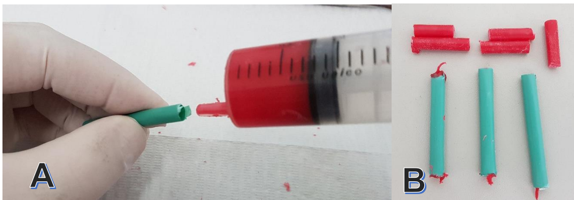
Figura 15: A- Injeção da resina fluida dentro do canudo; B- bastões aguardando remoção dos canudos e bastões concluídos.
