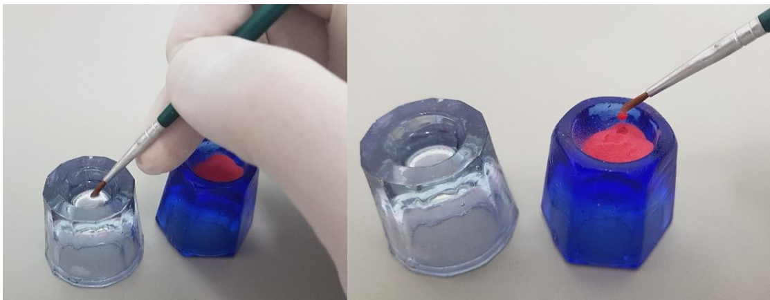
Figura 18: Execução da técnica do pincel (Nealon Technique). Pincel é molhado no monômero (líquido) e em seguida entra em leve contato com o polímero (pó).
