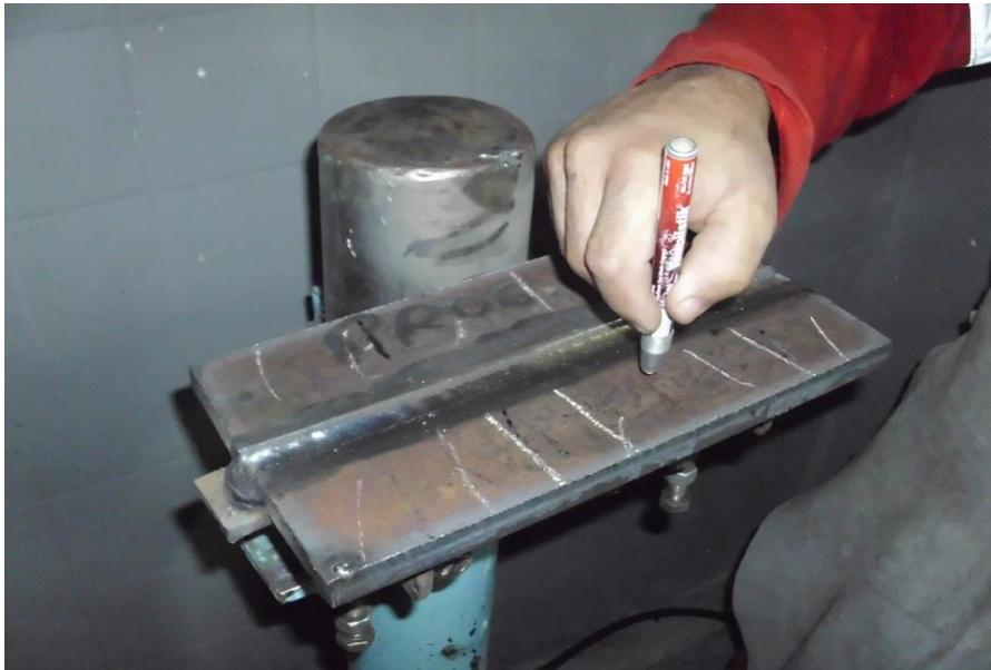
Figura 12. Detalhe da sequência de soldagem com eletrodo revestimento
