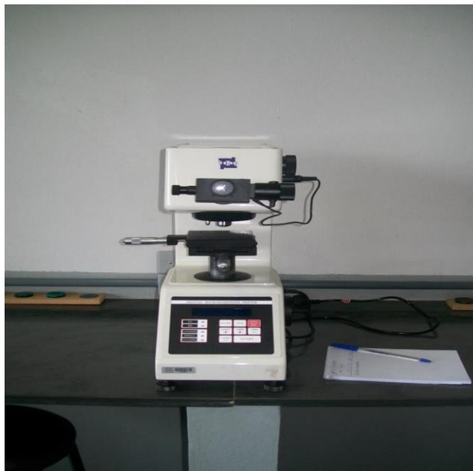
Os pontos de teste foram tornados sobre uma reta vertical, que corresponde a linha de centro na junta soldada, indo do nível da superfície da chapa até a raiz da solda, nas posições correspondentes aos entalhes dos corpos-de-prova de impacto Charpy-V, conforme Figura II.10.
