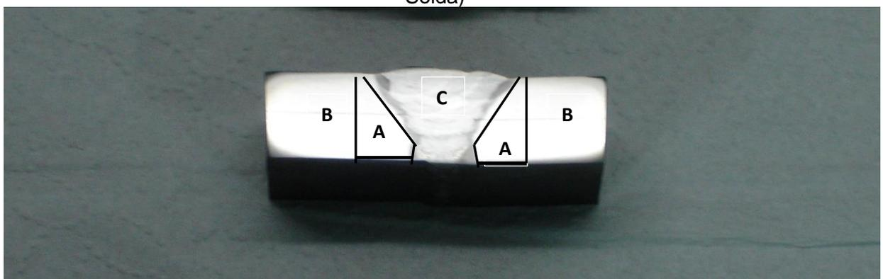
Arame Tubular - **A** (Zona Termicamente Afetada); **B** (Metal de Base); **C** – (Metal de Solda)
