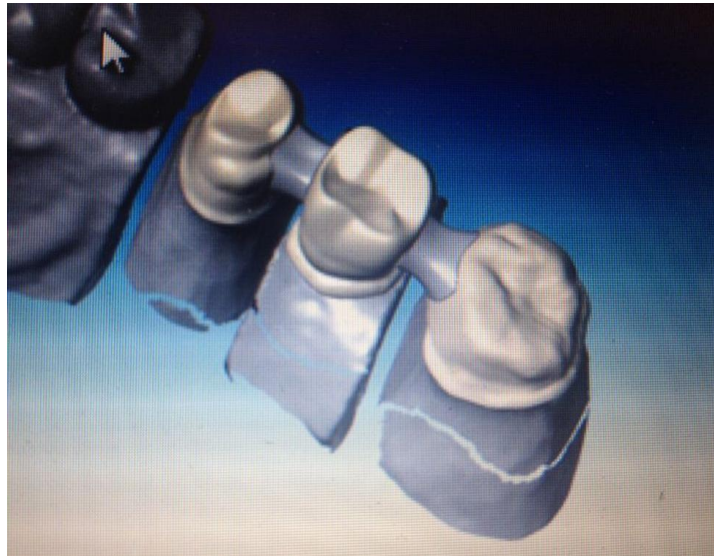
Figura 10: Design CAD da infra estrutura de 03 elementos.
