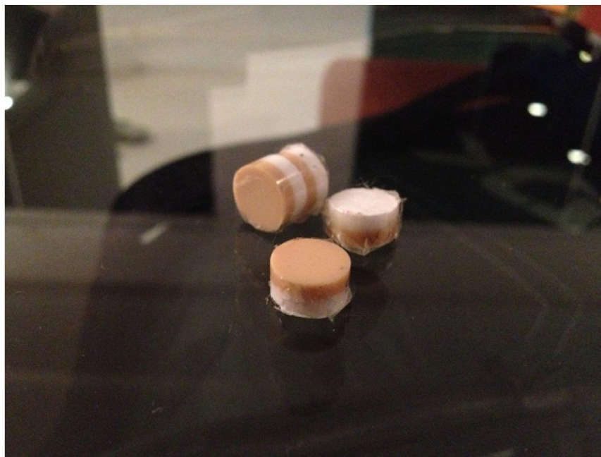
Figura 21: Imagem representativa de corpo de prova cilíndrico após sinterização com destaque para diferença de coloração entre as regiões.
