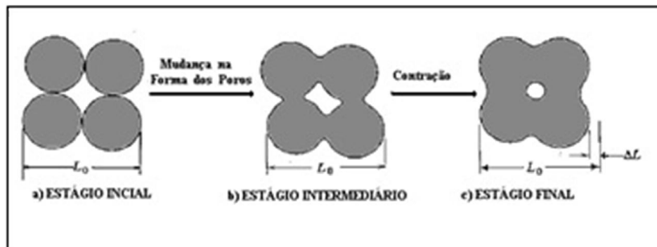
Figura 3: Variação da porosidade e conseqüente retração, durante o processo de sinterização no estado sólido [25].
