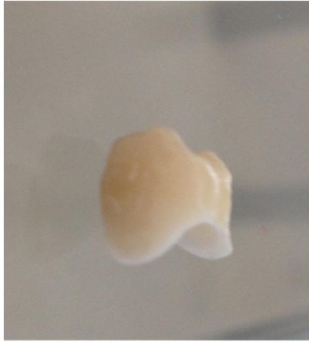
Figura 17: Amostra monocromática após quarta queima evidenciando o halo opaco na região cervical.
