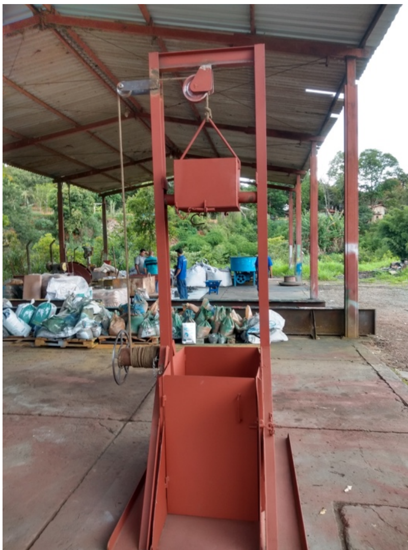
Figura 43: Equipamento de Shatter Test utilizado na planta piloto de Santa Luzia, MG
