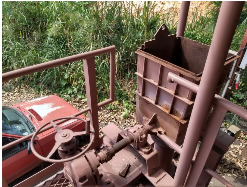
Figura 35: Painela e sistema de basculamento
