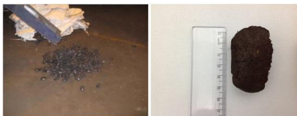
Figura 3.5: (a) Confecção dos briquetes; (b) Briquete obtido na RENOVA.
