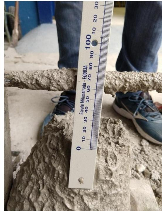
Imagem da medição do *Slump* Test .
