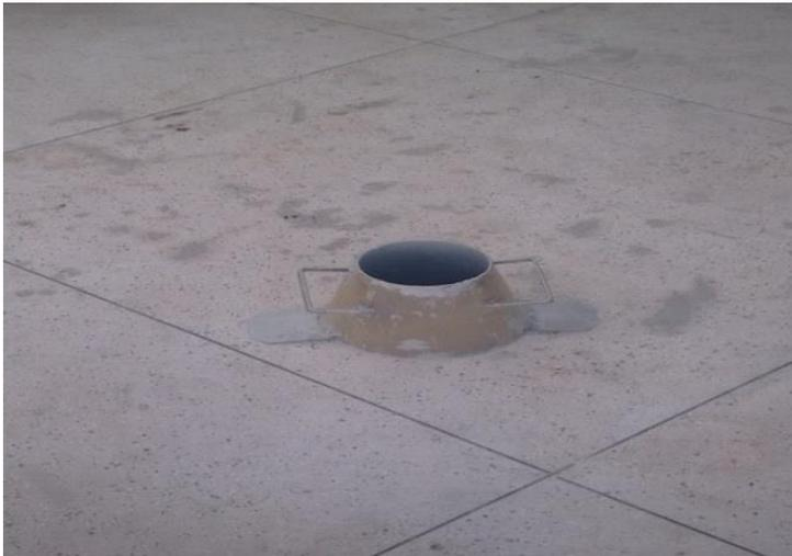
Cone de Abrans para *Slump* Test.
