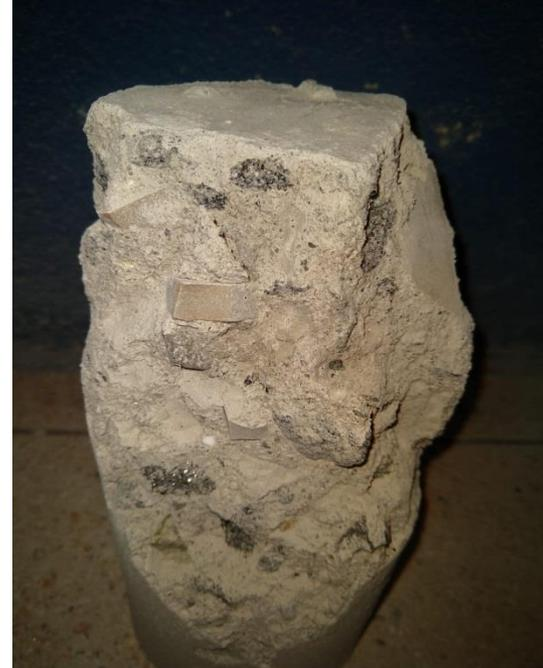
Corpo de prova após o ensaio de compressão.
