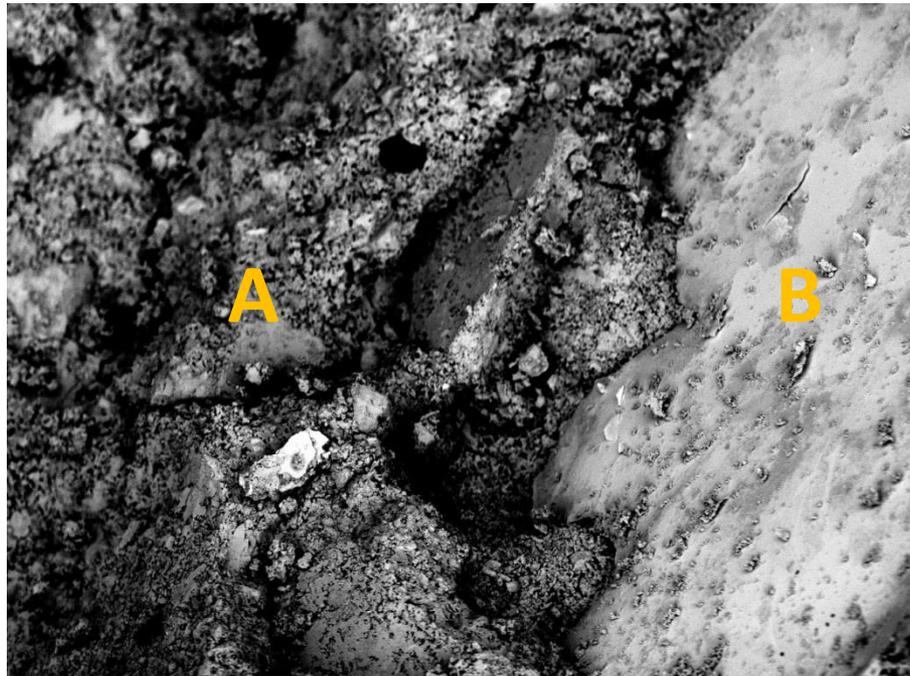
Micrografia obtida com aumento de 200x para amostra com 10% de adição de cerâmica e 28 dias de cura.
