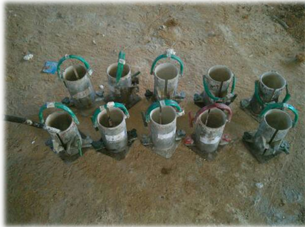
Formas Cilíndricas nas dimensões 10cm x 20cm
