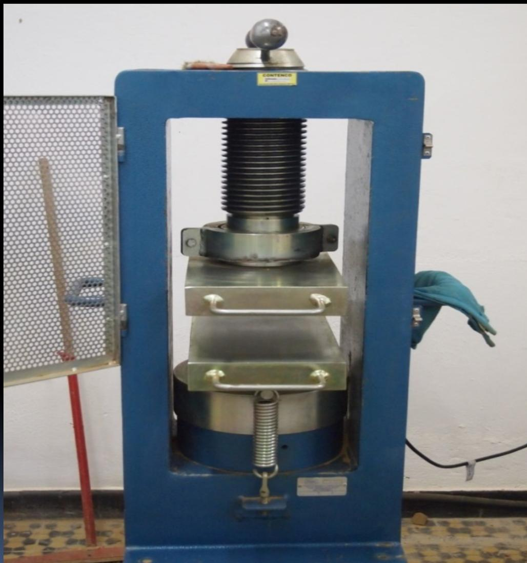
Retirada da ranhura para ensaio de resistência à compressão
