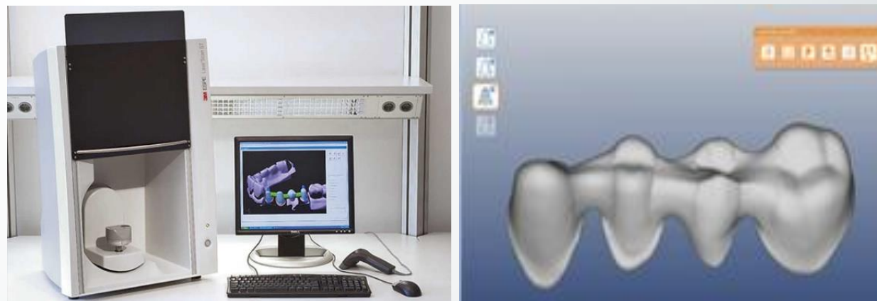
Figura: 5 tipo sistema CAD/CAM para odontologia: (a) sistema de escaneamento de imagens; (b) modelo de próteses criado por computador
