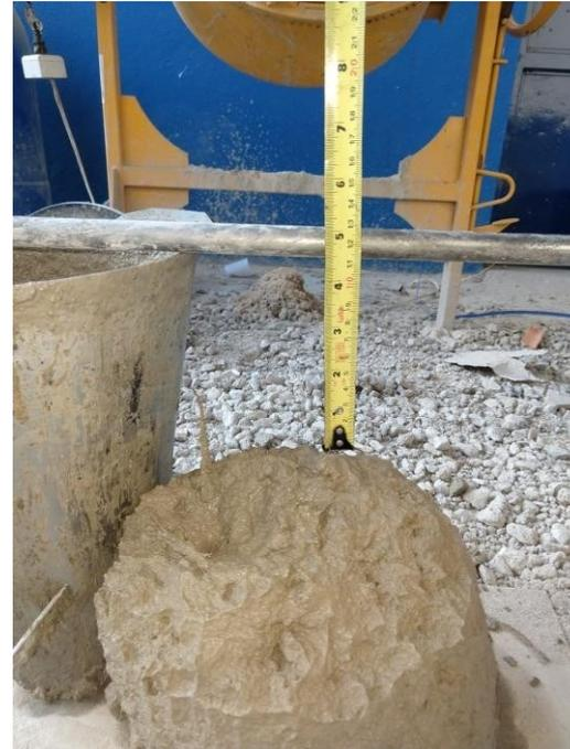
Imagem da medição do *Slump* Test .
