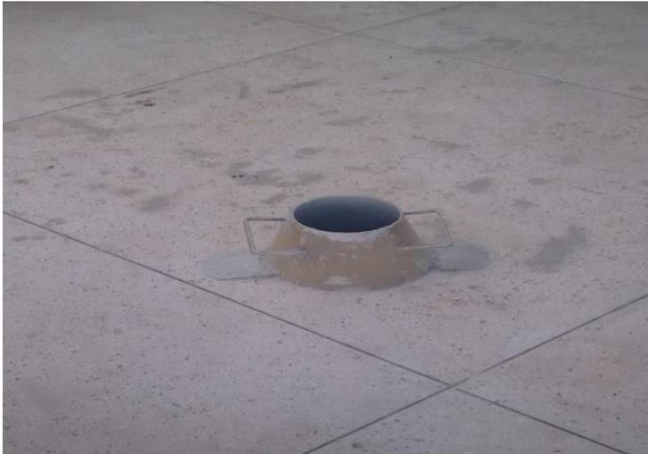
Cone de Abrans para *Slump* Test.
