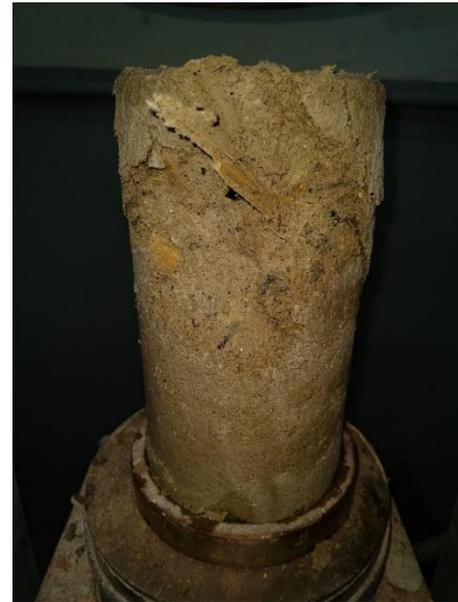
Corpo de prova após o ensaio de compressão.
