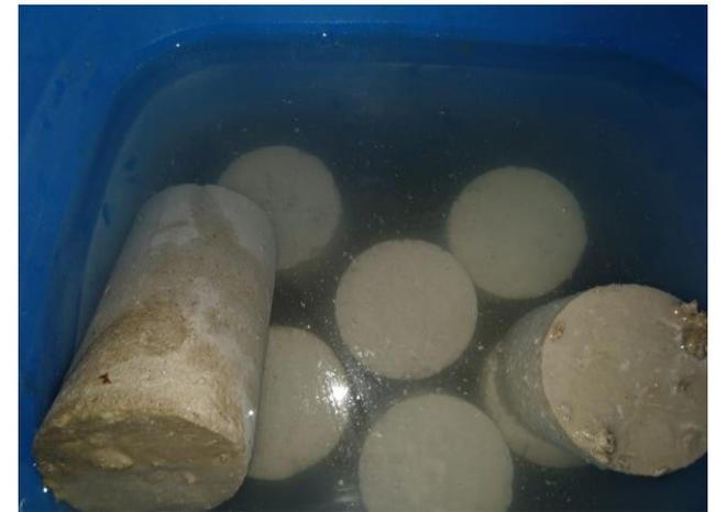
Corpos de prova imersos em água na câmara de cura.
